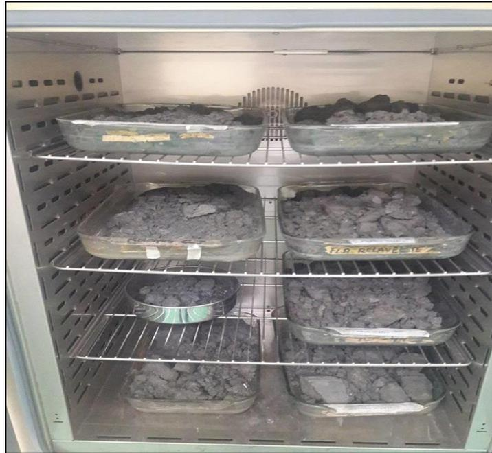
Figura 7: Secado del material
