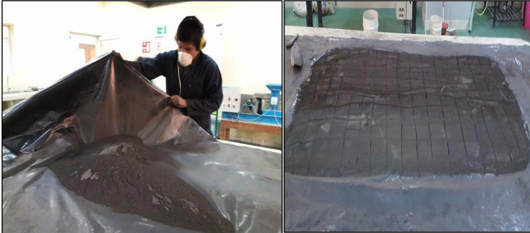
Figura 8: Homogenización y cuarteo de la muestra
