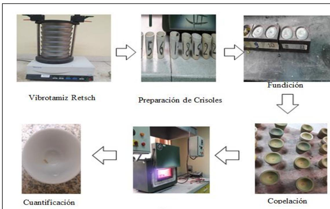
Figura 16: Proceso pirometalúrgico de mallas valoradas
