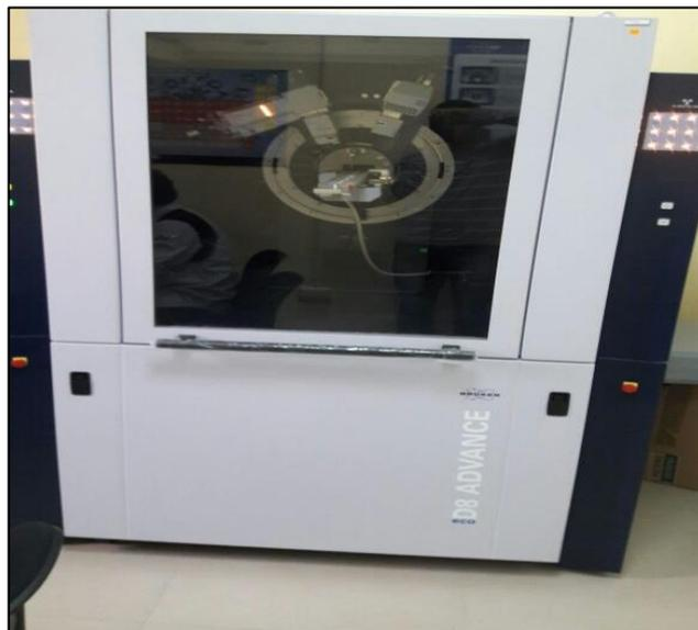
Figura 14: Equipo Bruker D8 ADVANCE ECO <sup>29</sup>.
