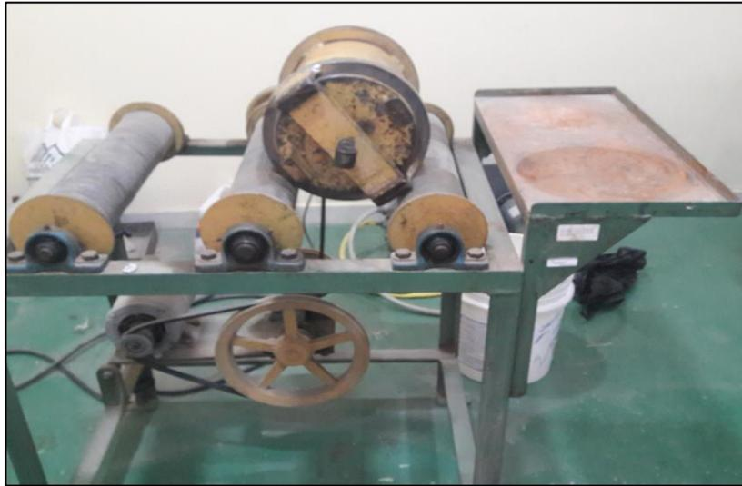
Figura 17: Molino de bolas batch modelo C560394
