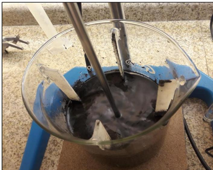
Figura 18: Agitador Mecanico a escala laboratorio con celda modelo DENVER
