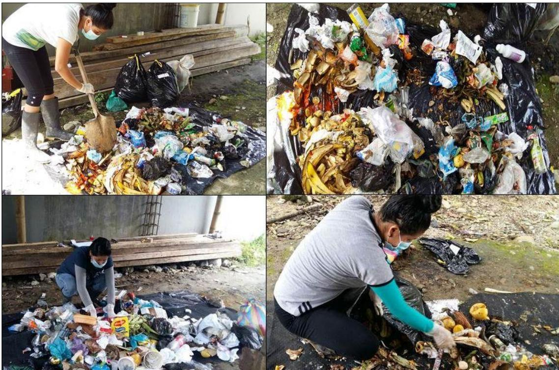
**Imagen 10** Realización del método del cuarteo para la clasificación de residuos sólidos
