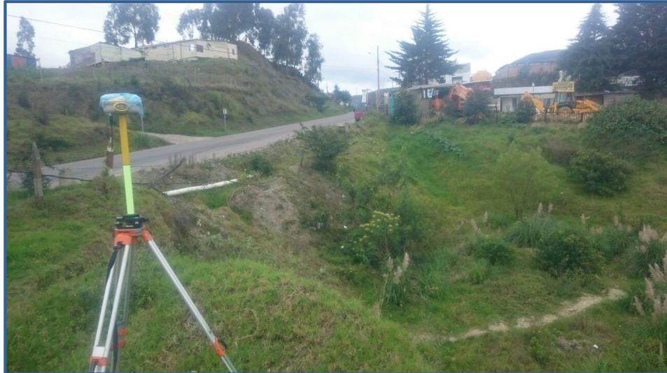
**Figura 10.** Levantamiento topográfico Talud 1 km 2+900
