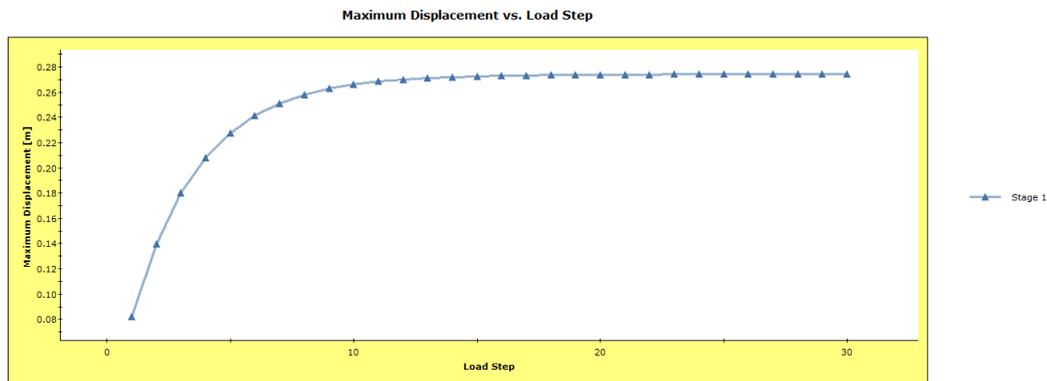
**Figura 38.** Talud km 2+900 Perfil 2 Modelación implementada la subbase clase III, geotextil H2Ri y suddren se obtiene un FS = 1.61
