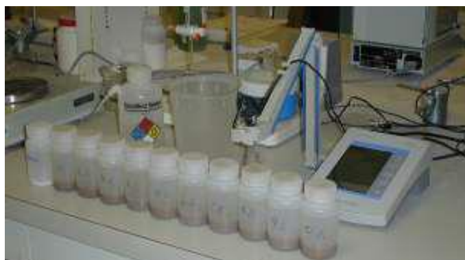
Figura 14. Ensayo del pH para estimar la cantidad de cal necesaria.
