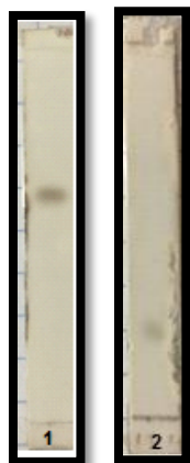
Figura 17. Cromatografía en capa fina de la fracción MicroAcOEt_7, polaridad: (1) Hex: \text{CH}_2\text{Cl}_2 7:3; polaridad (2) Hex: \text{CH}_2\text{Cl}_2 9:1
