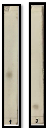
Figura 18. Cromatografía en capa fina de la fracción JnAcOEt_9, Polaridad (1) Hex:CH 2 Cl 2 2:8; polaridad (2) Hex:CH 2 Cl 2 7:3
