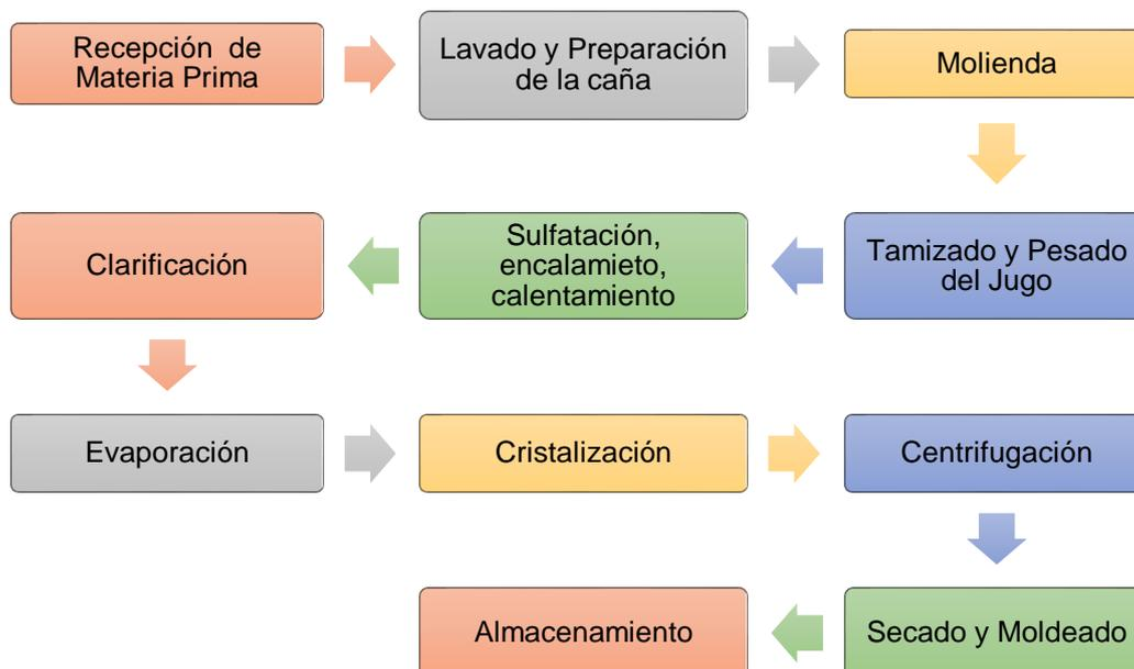
**Ilustración 1:** Diagrama del proceso de producción de panela.
