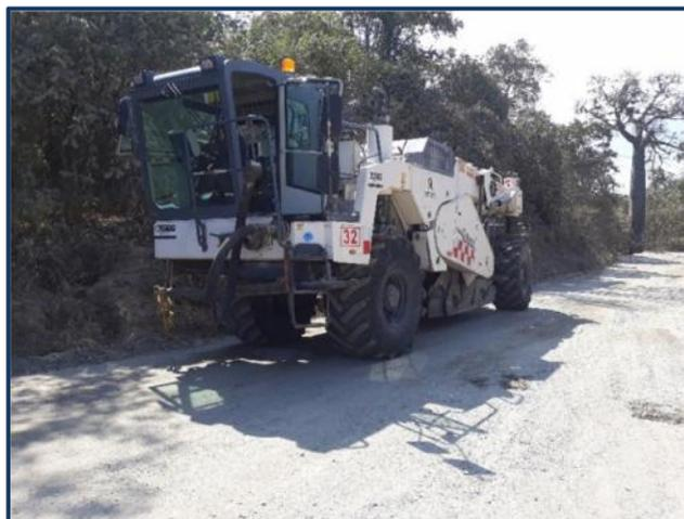
Imagen 12. Recicladora para inyectar emulsión asfáltica, vía Pindal-Paletillas
