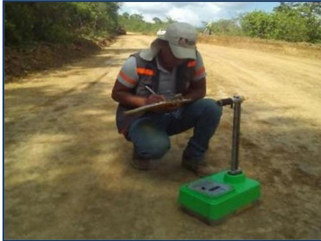
Imagen 4. Control de calidad de acabado de obra básica, toma de densidades, vía Pindal-Paletillas personal de fiscalización.
