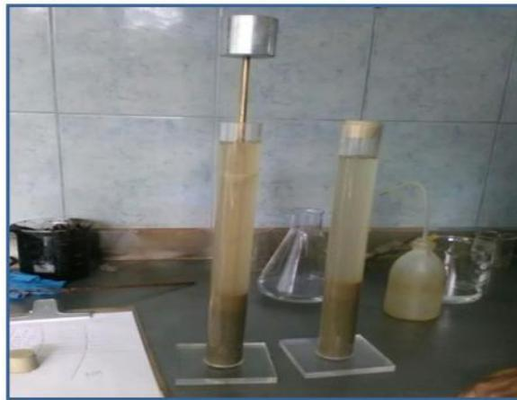
Imagen 20. Ensayo Equivalente de Arena, mina Potrerillos
