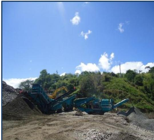
Imagen 23: Trituración de materiales para carpeta asfáltica
