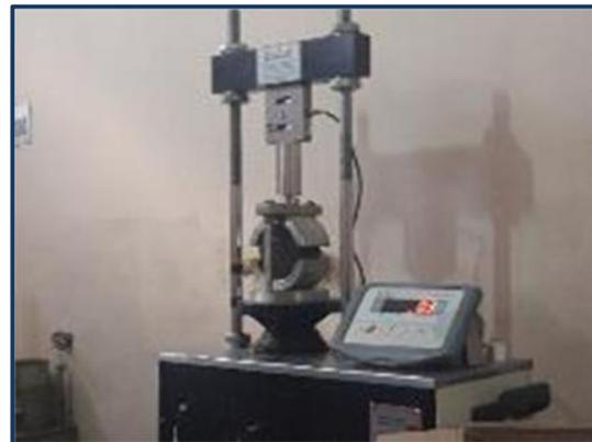
Imagen 15. Control de calidad de material de base, a. control de espesor, b. elaboración de briquetas in situ, c. ensayo asfalto residual, d. ensayo Marshall, vía Pindal-Paletillas
