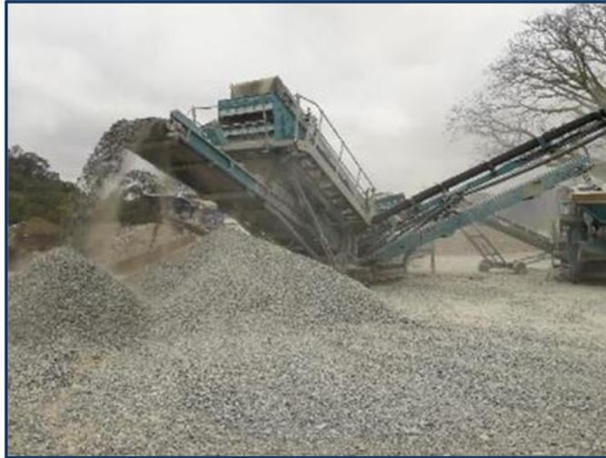
Imagen 9. Trituración de material para base, sector saucillo, vía Pindal-Paletillas
