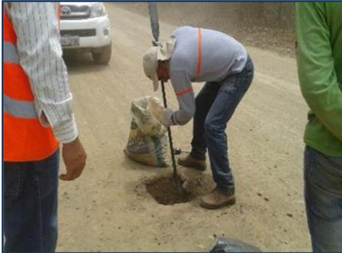
Imagen 8. Control de calidad de la subbase clase III, vía Pindal-Paletillas, personal de fiscalización.
