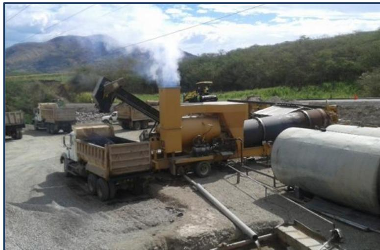
Imagen 25. Planta de fabricación de hormigón asfáltico
