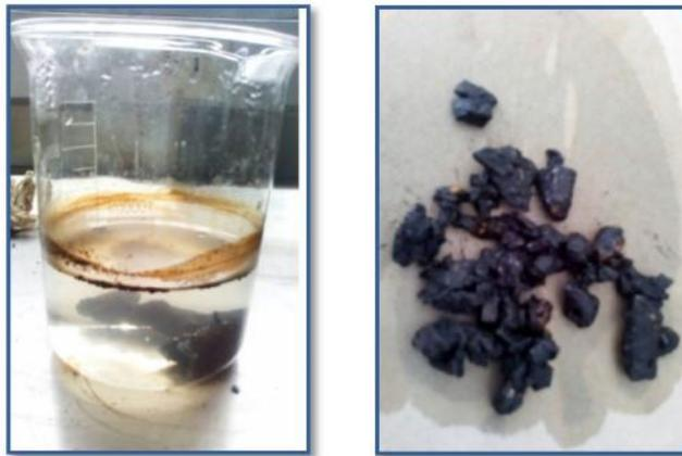
Imagen 22. Ensayo de compatibilidad y peladura, mina Potrerillos
