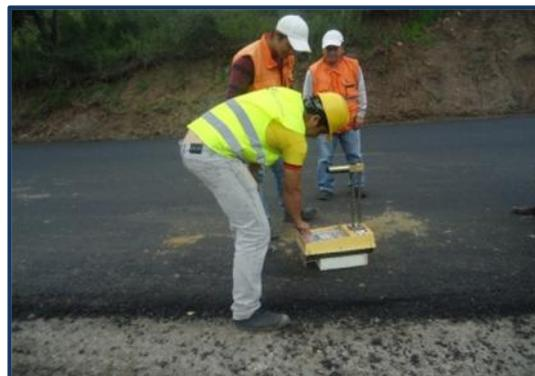
Imagen 29. Densidades de la mezcla asfáltica
