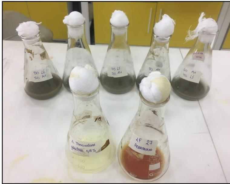
**Figura 3.25.** Inoculación de proporción de cada especie microbiana sobre el mineral aurífero refractario.
