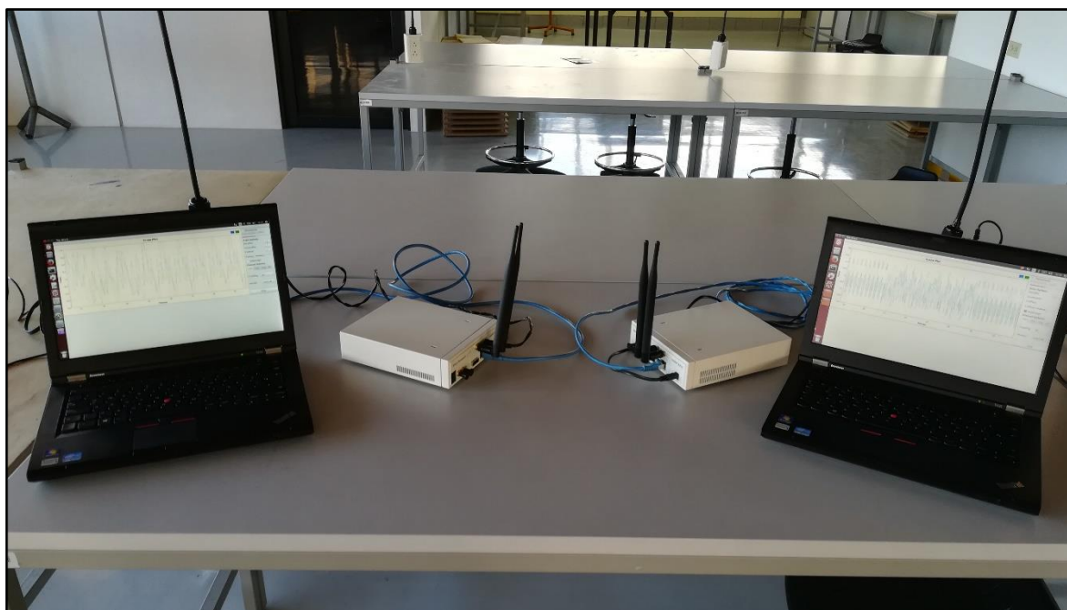
Figura 3.5. Conexión del sistema para las pruebas de los algoritmos con USRPs
