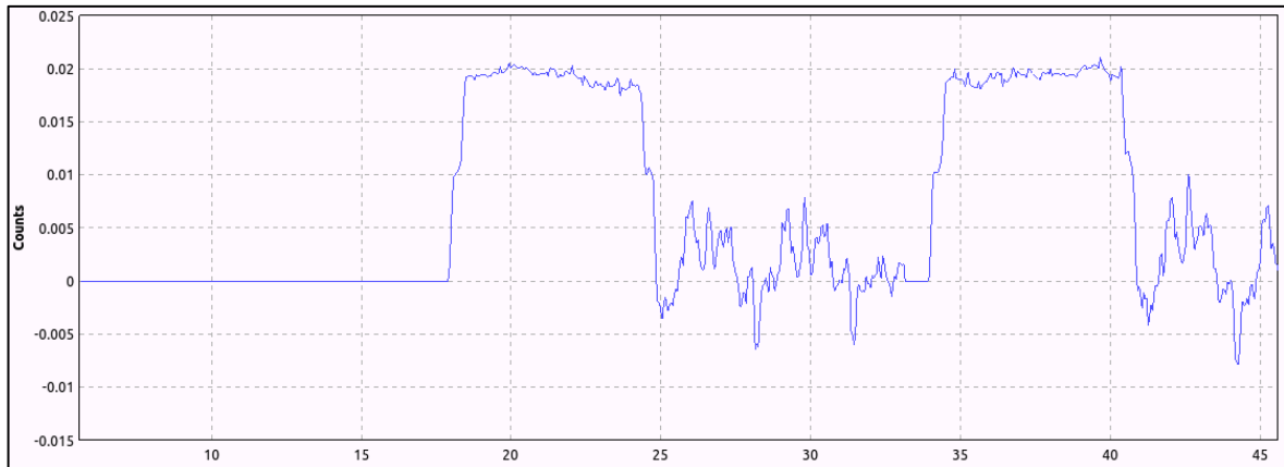
Figura 3.13. Respuesta temporal de la autocorrelación usada para la detección de CFO, implementada con los USRPs a 30 centímetros de separación.
