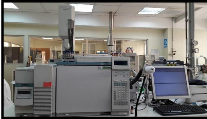
**Figura 4.** Cromatógrafo de gases acoplado a espectrometría de masas.
