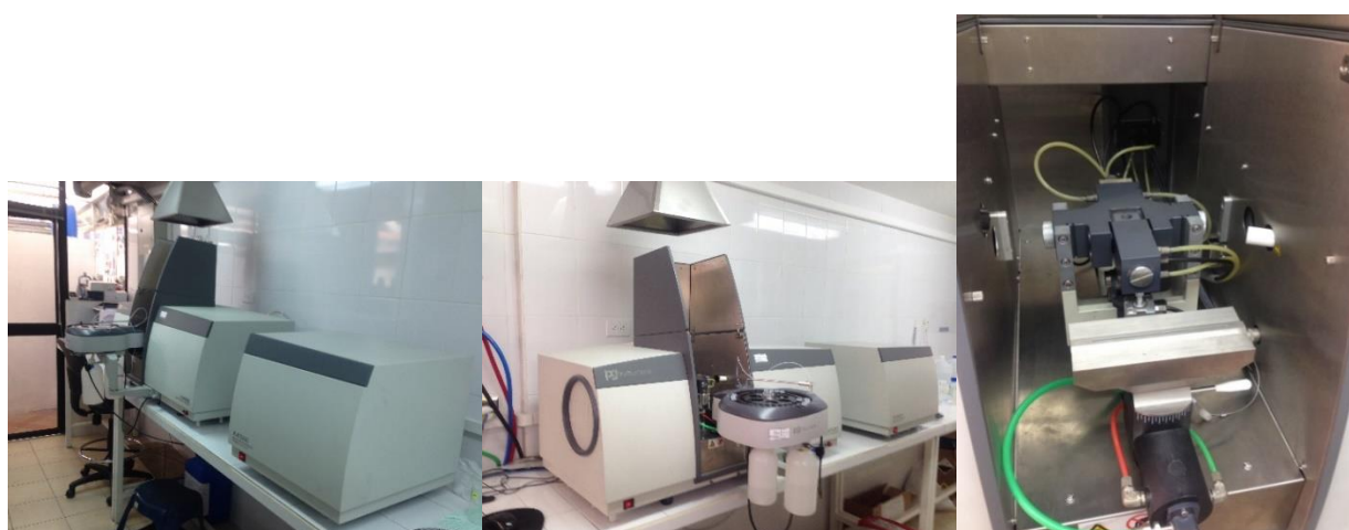
Figura 19. Espectrofotómetro de absorción atómica dotado con horno de grafito y llama. Fuente y Elaborado por: Gómez, Alvaro. 2017
