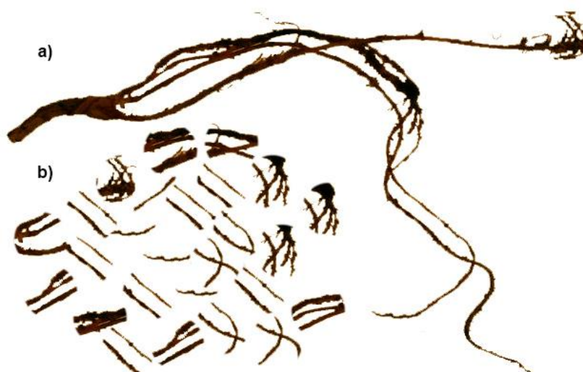
Figura 6: a) Fibra del mesocarpio, b) Fibra cortada 2 cm aproximadamente
