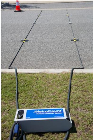
Figura 24. Disposición en la vía del contador neumático
