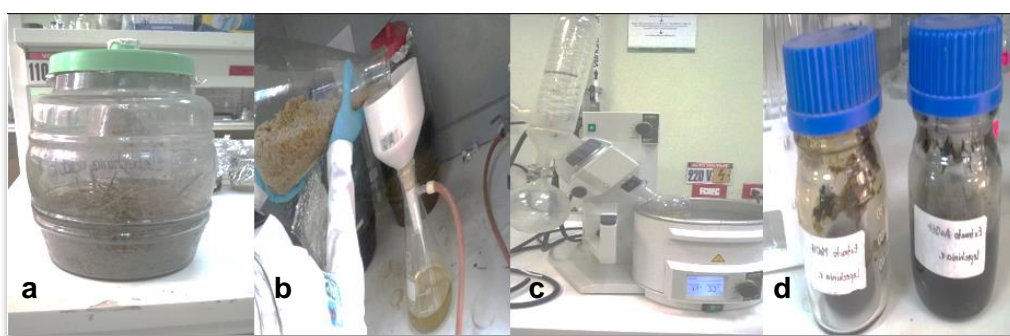
Figura 3 Obtención de extractos totales. a) Maceración, b) Filtración al vacío, c) Rotaevaporación a presión reducida, d) Extractos Totales
