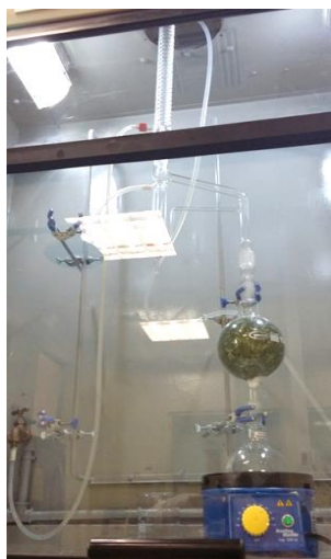
Figura 8: Destilación por arrastre de vapor. Fuente: Laboratorio de Síntesis Química. Elaboración: La autora.
