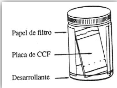
Figura 4: Método para corrida de Cromatografía en Capa Fina. Fuente: (Unam, 2007). Elaboración: (Unam, 2007).
