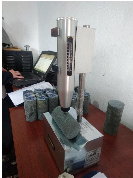
Figura 22. Ejecución y medición del valor de rebote R con martillo Schmidt de bajo impacto.
