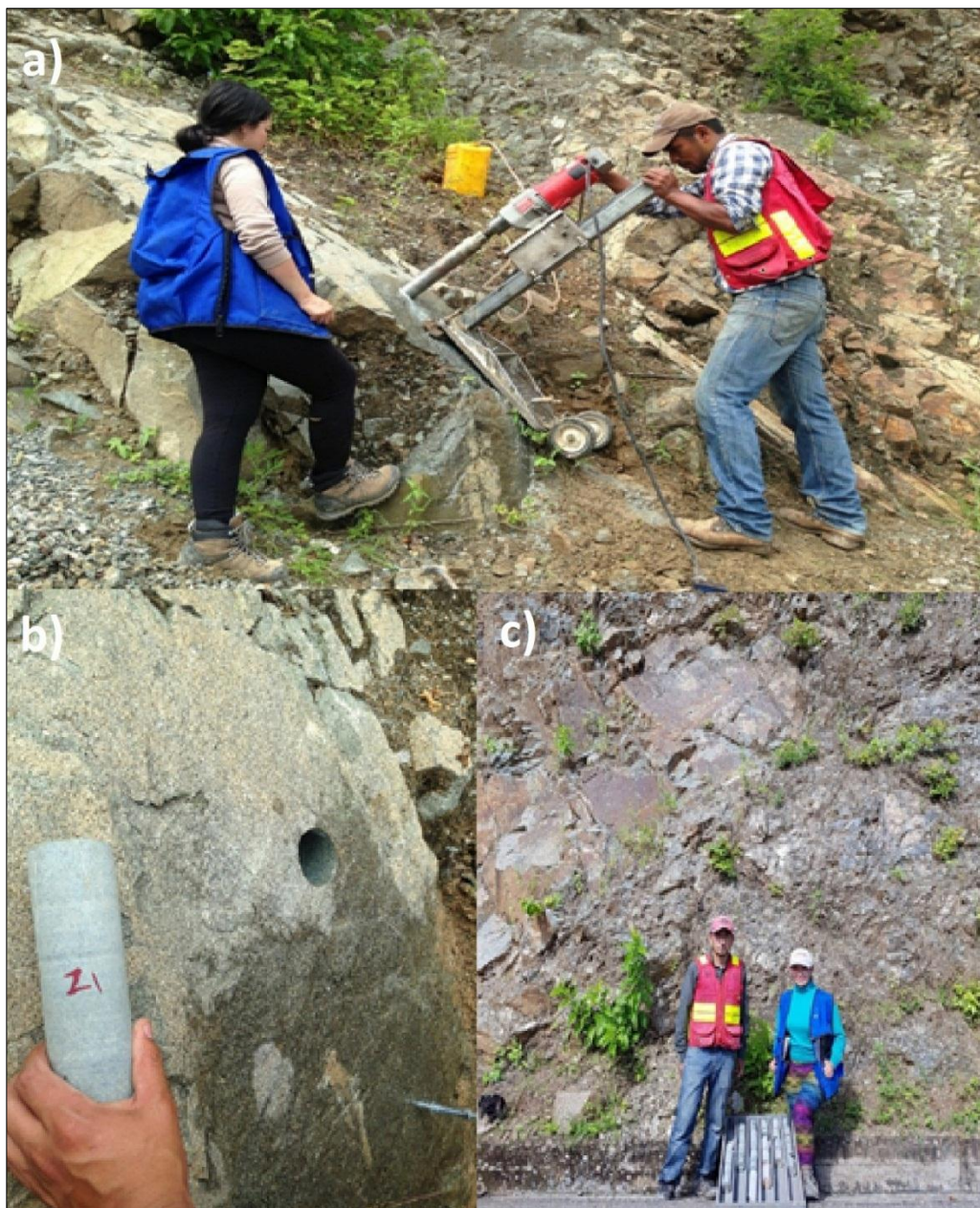
Figura 18. Campaña de testificación, a) ejecución de la labor de perforación, b) recuperación de testigo de perforación, c) personal de campo junto al total de muestras extraídas.
