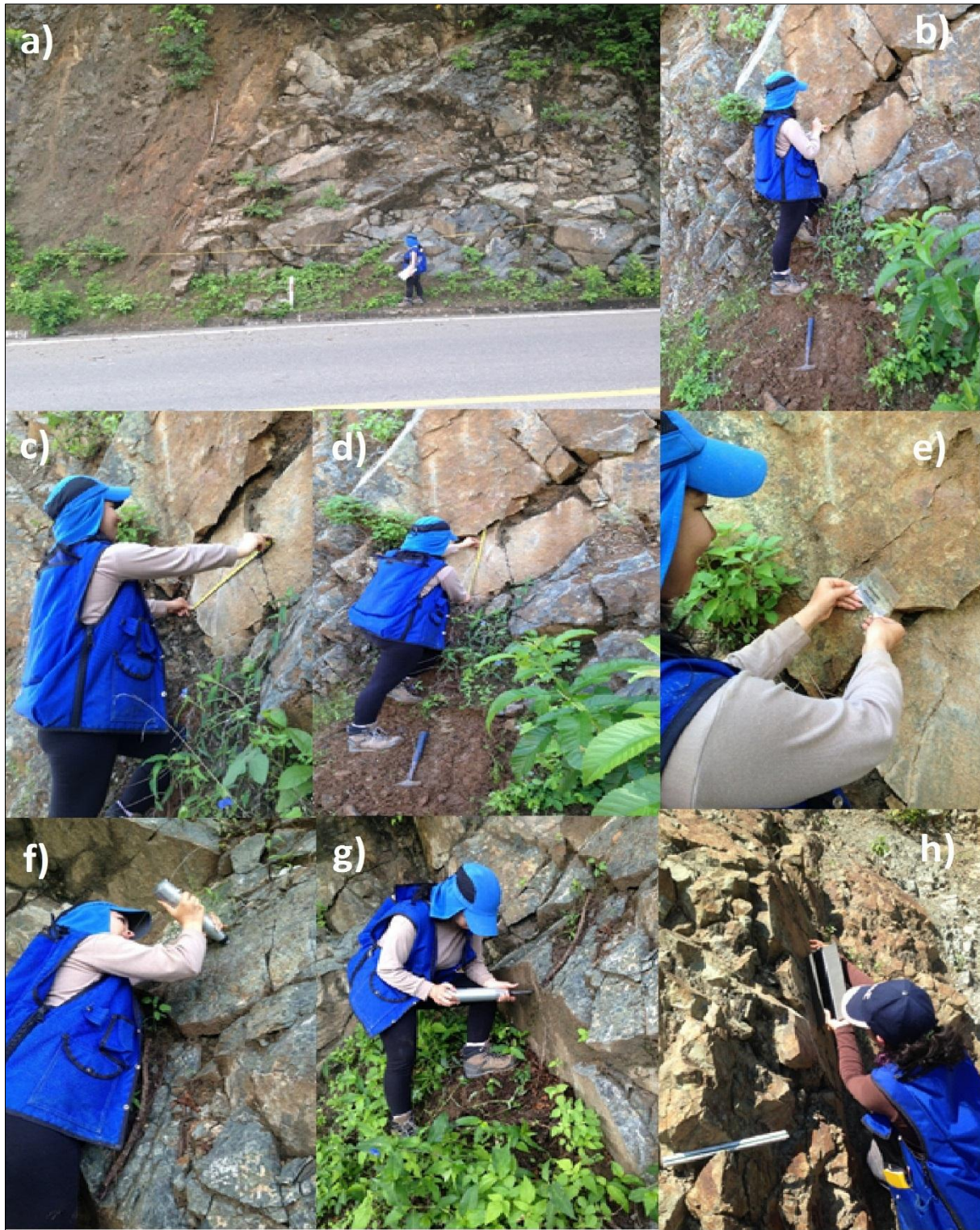
Figura 17. Campaña de toma de datos geomecánicos, a) Colocación de línea de escaneo, b) medida de separación, c) y d) medida de longitud (rumbo-buzamiento), e) medida de aberturas, f) y g) ejecución de ensayo de esclerometría de bajo impacto, h) medida de rugosidad peine de barton
