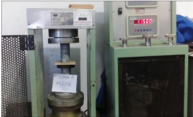
Figura 20. Ensayo de resistencia a la compresión simple. Fuente: la autora Elaborado: por la autora
