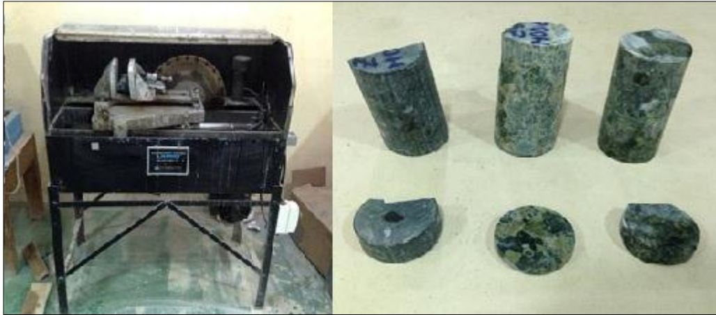
Figura 24. Campaña de laboratorio, a la izquierda maquina cortadora de roca LAPRO 48; a la derecha núcleos y secciones delgadas correspondientes zonas litológicas.
