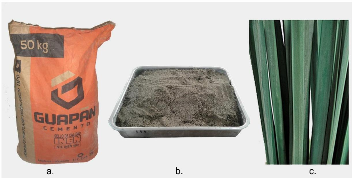
**Figura 11.** Cemento Portland Pozolánico Tipo IP (a). Arena fina (b). Planta de totora (c).
