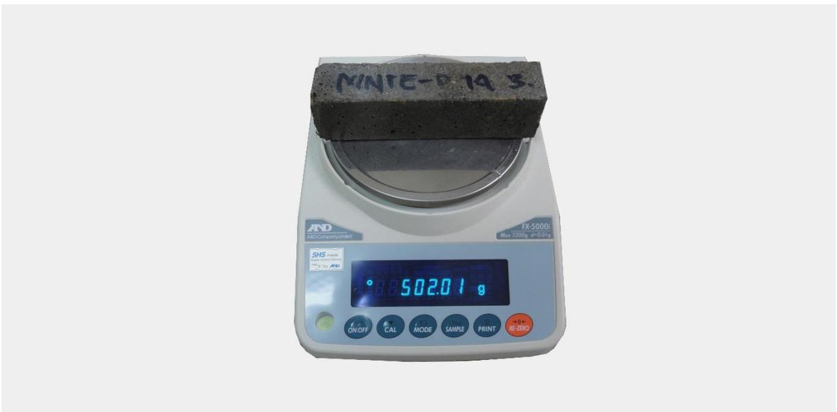
**Figura 44.** Pesaje del espécimen en la balanza eléctrica.
