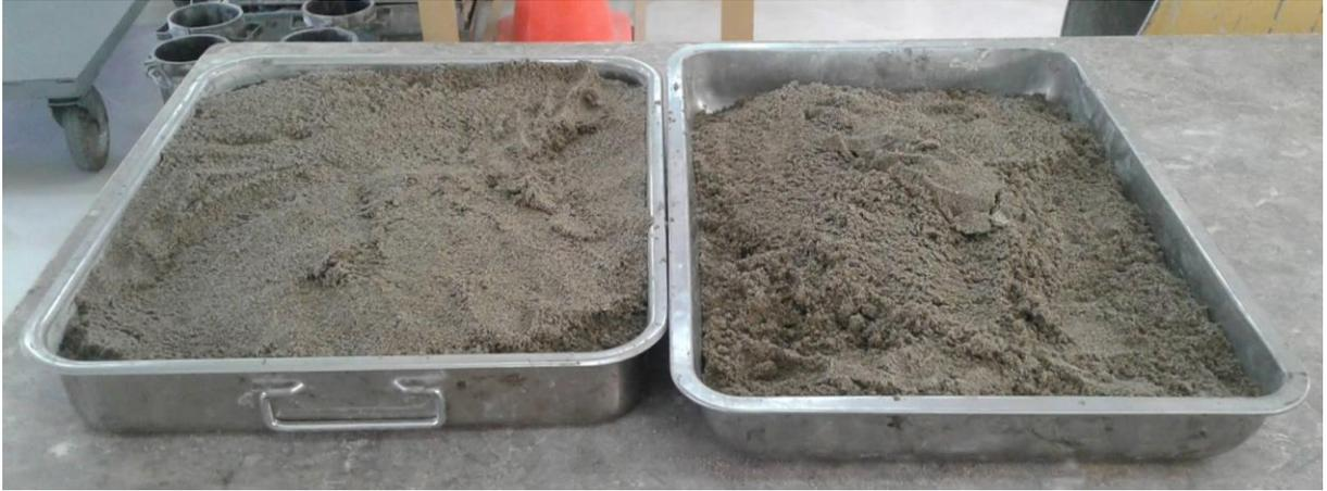
**Figura 15.** Bandejas conteniendo arena para el previo secado en el Horno.
