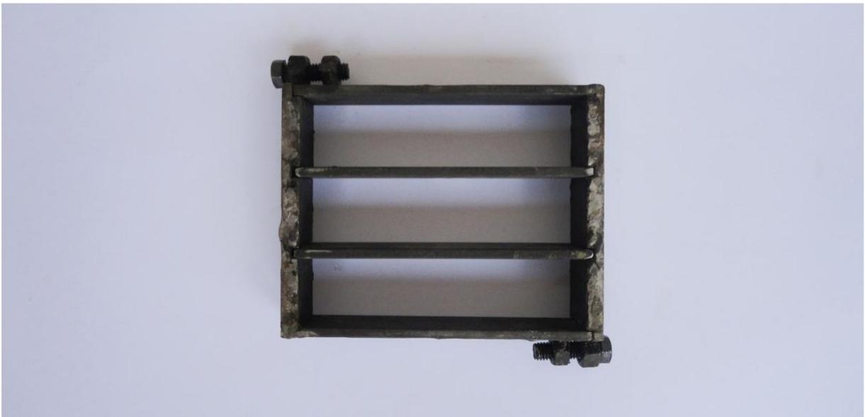
**Figura 20.** Molde con las divisiones interiores para los 3 especímenes.
