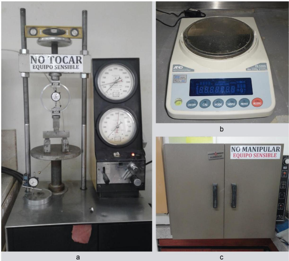
**Figura 41.** Maquina Versa Tester (a). Balanza modelo FX-5000i (b).Horno de banco (c).
