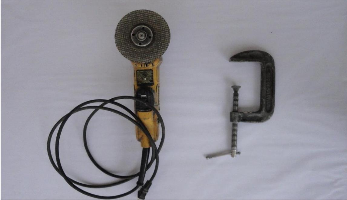
**Figura 54.** Instrumentos utilizados para sacar los especímenes a compresión.
