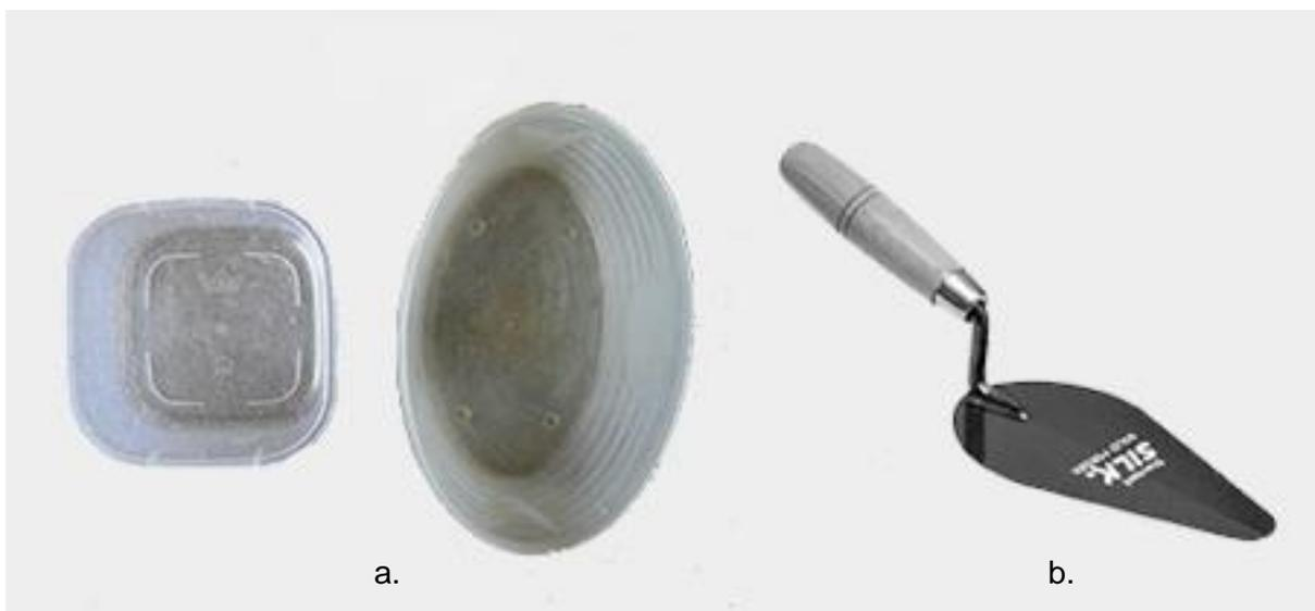
**Figura 18.** Fuente para la mezcla (a). Bailejo para mezcla (b).
