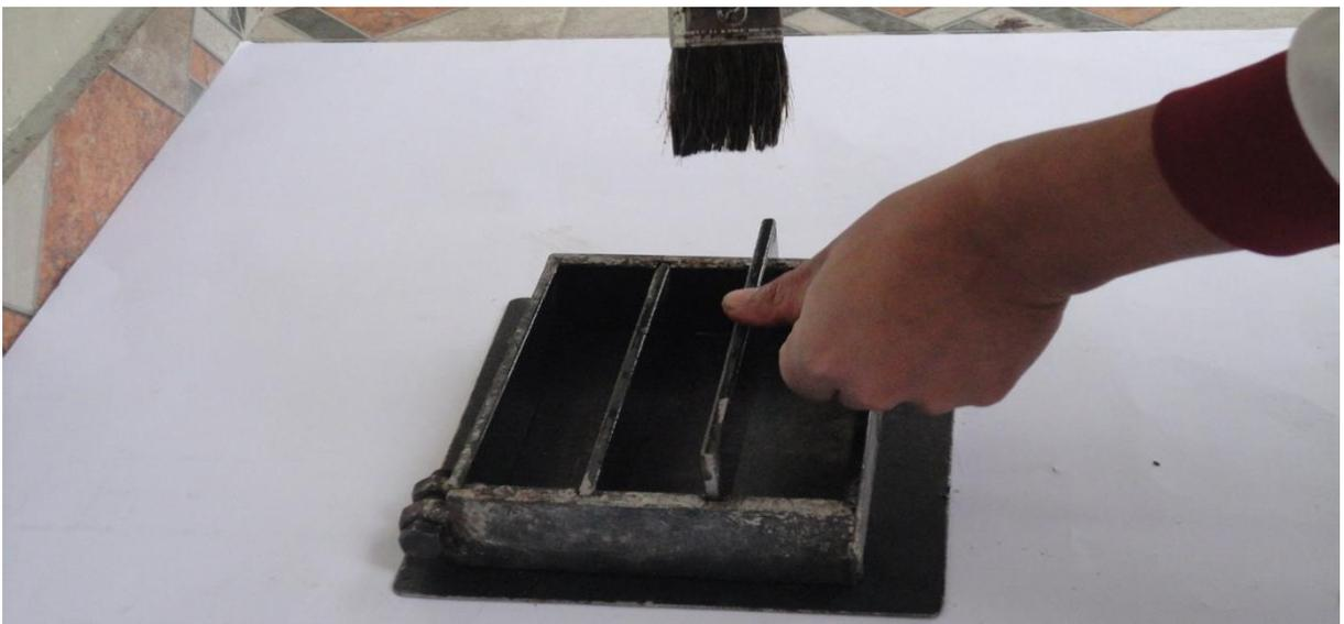
**Figura 22.** Se utiliza aceite quemado para cubrir la superficie.
