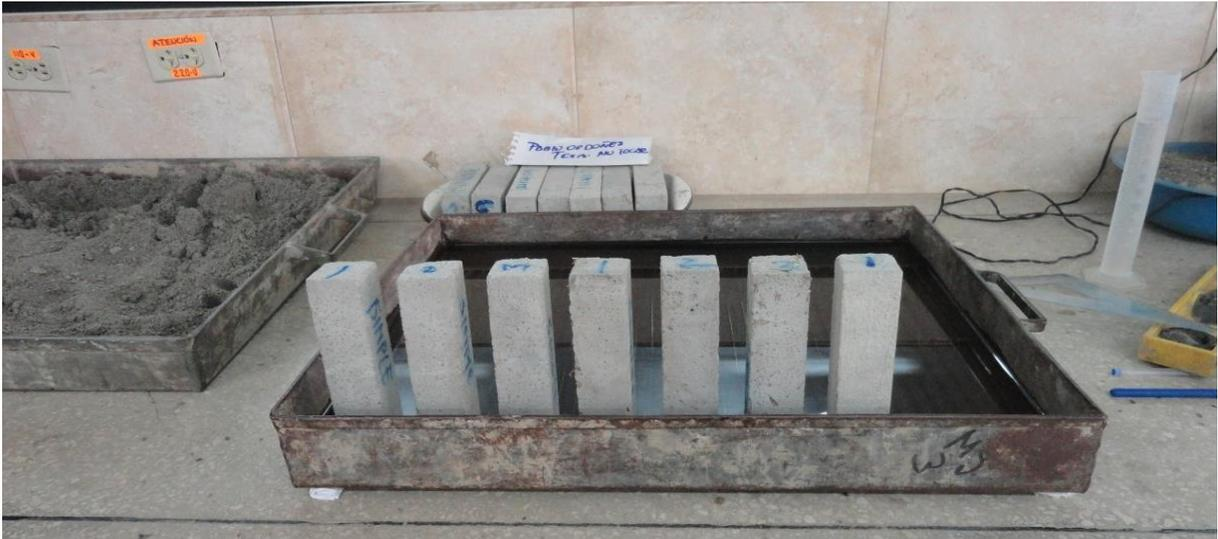
**Figura 80.** Probetas puestas en posición vertical para el proceso de capilaridad.
