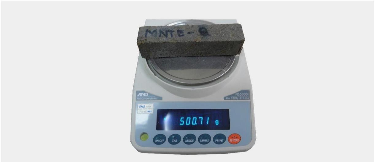
**Figura 69.** Peso inicial de la probeta
