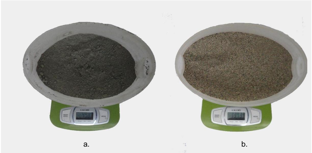
**Figura 24.** Pesaje del cemento en la balanza (a). Pesaje del árido en la balanza (b).
