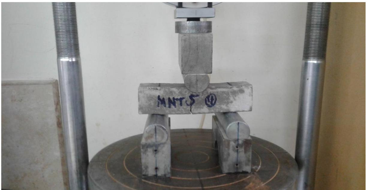
**Figura 46.** Probeta puesta en la máquina para la prueba a flexión.
