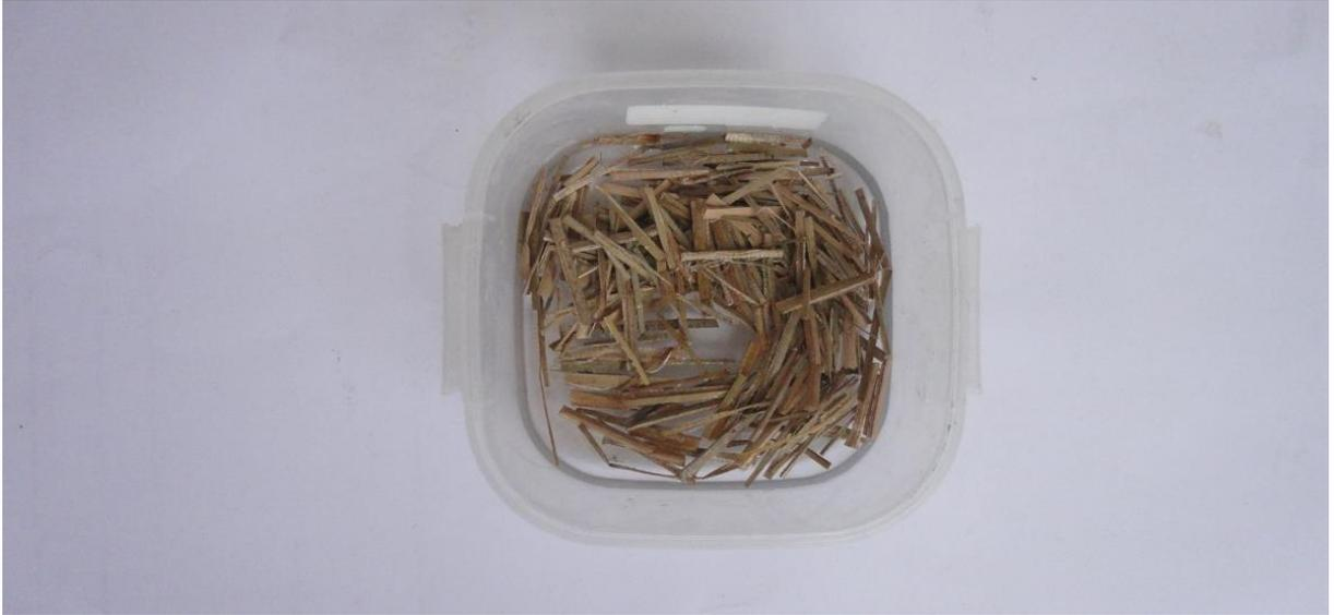
**Figura 38.** Fibra sumergida en la composición química.
