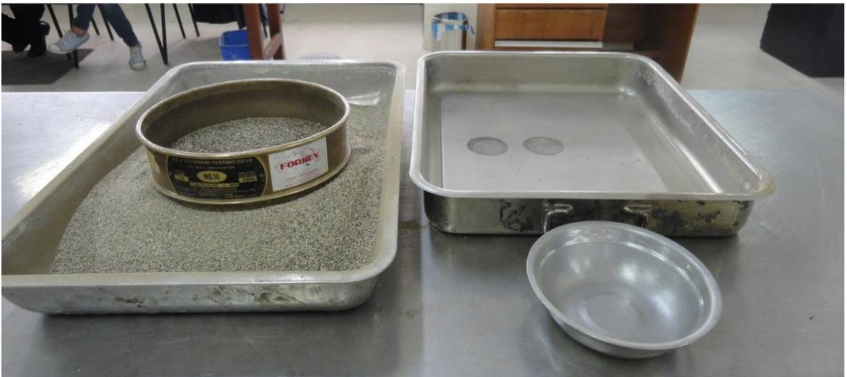
**Figura 16.** Bandejas conteniendo arena secada para el tamizado.
