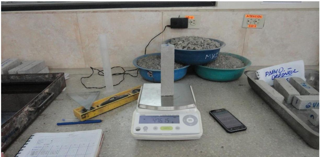
**Figura 79.** Pesaje inicial después del secado en el horno.
