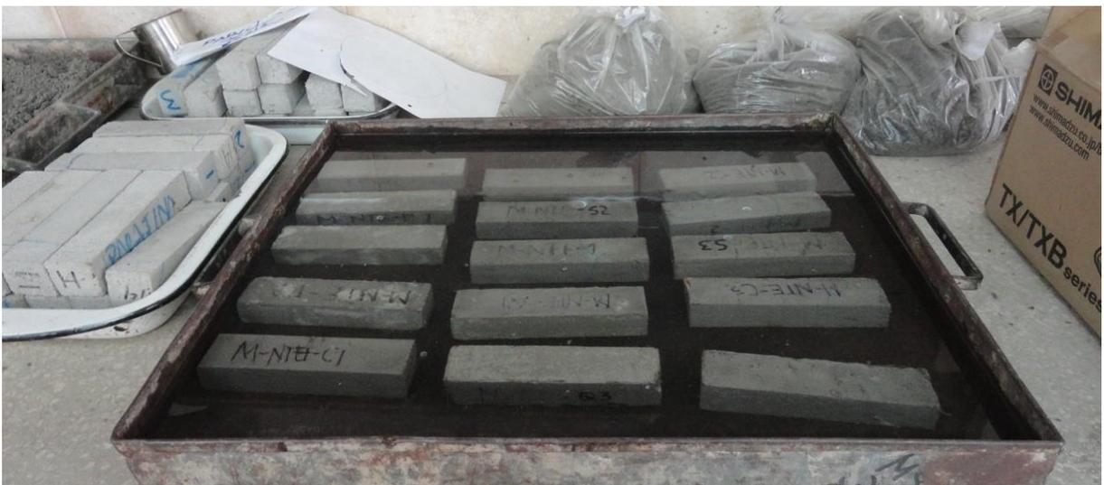
**Figura 75.** Probetas sumergidas en agua.
