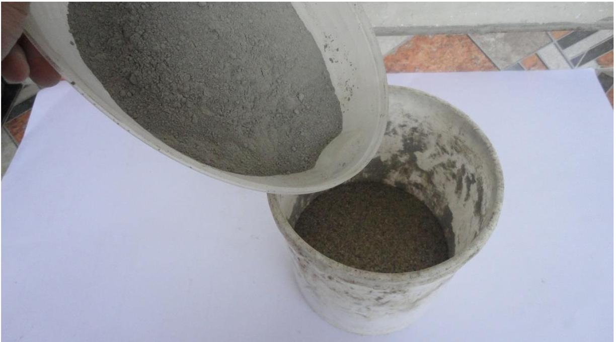
**Figura 25.** Mezcla del cemento y arena.
