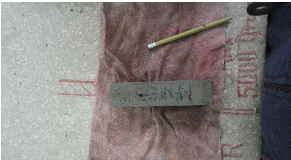
**Figura 76.** Secado de la probeta para después pesarla.
