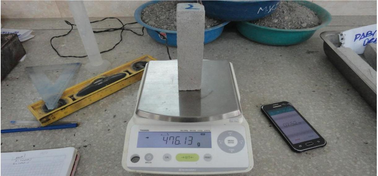
**Figura 74.** Pesaje de las probetas después del secado en el horno.
