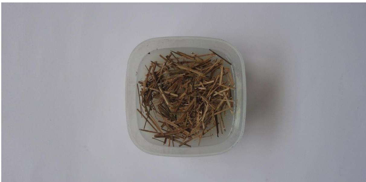
**Figura 40.**Fibra sumergida en la composición química.
