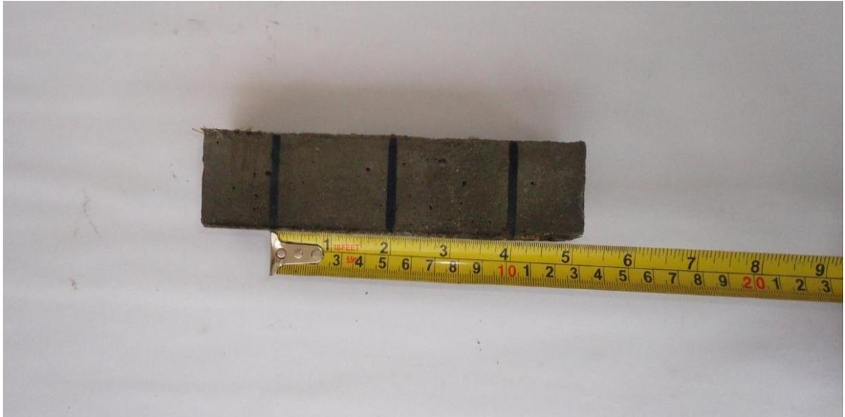
**Figura 45.** Marcaje de donde van ir los apoyos para las pruebas a flexión.
