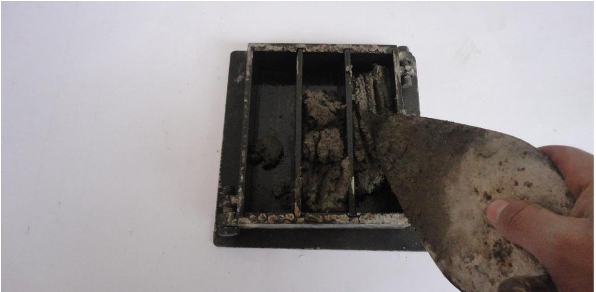
**Figura 28.** Vaciado dentro del molde.
