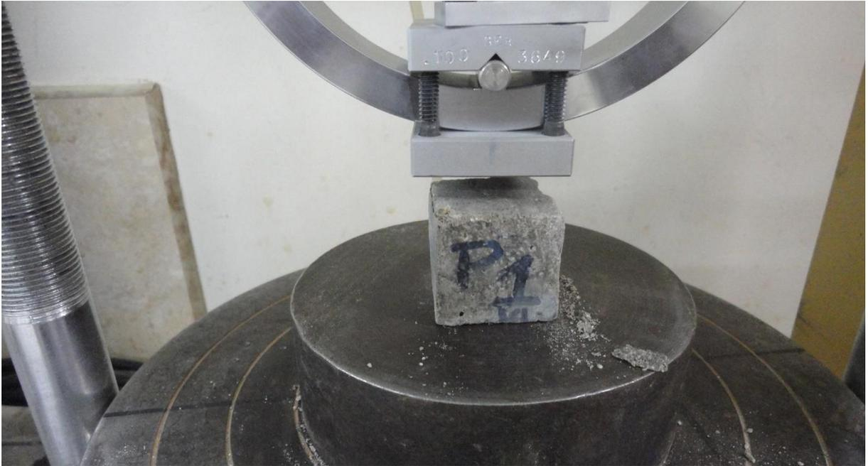
**Figura 60.** Probeta puesta en la máquina para la prueba compresión.
