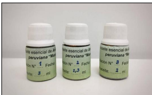
Figura 11. Aceite esencial Ambrosia peruviana obtenido por destilación con arrastre de vapor.
