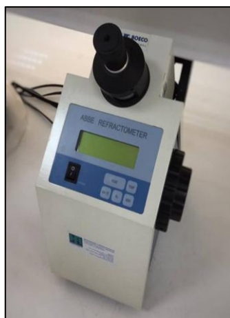
Figura 14. Determinación del índice de refracción del aceite esencial Ambrossia peruviana , refractómetro ABBE BOECO GERMANY.
