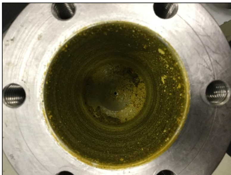
Figura 17. Extracto de Ambrossia peruviana obtenido con dióxido de carbono supercrítico (CO 2 -SC) , adherido a paredes del separador.
