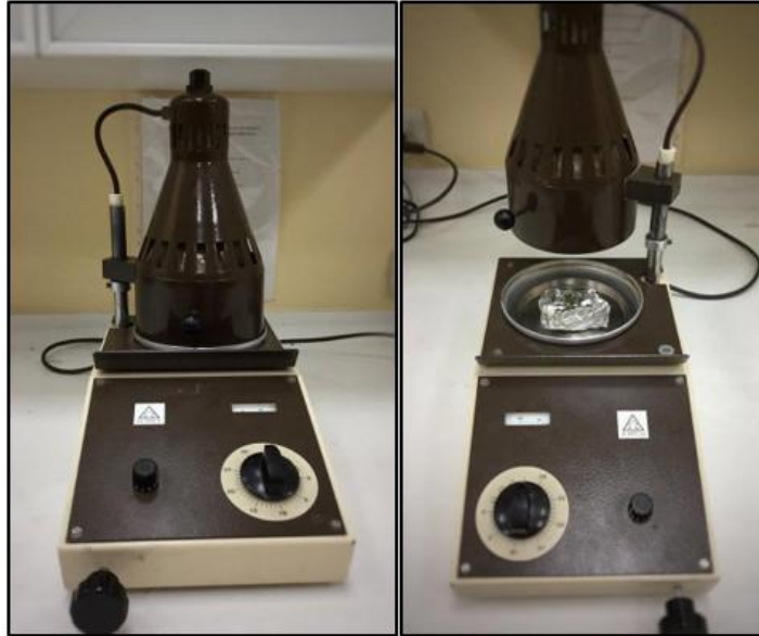
Figura 8. Determinación de humedad relativa de Ambrossia peruviana , lámpara de calentamiento modelo ULTRA X.
