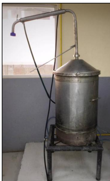
Figura 10. Destilador tipo Clevenger para extracción de aceites esenciales.
