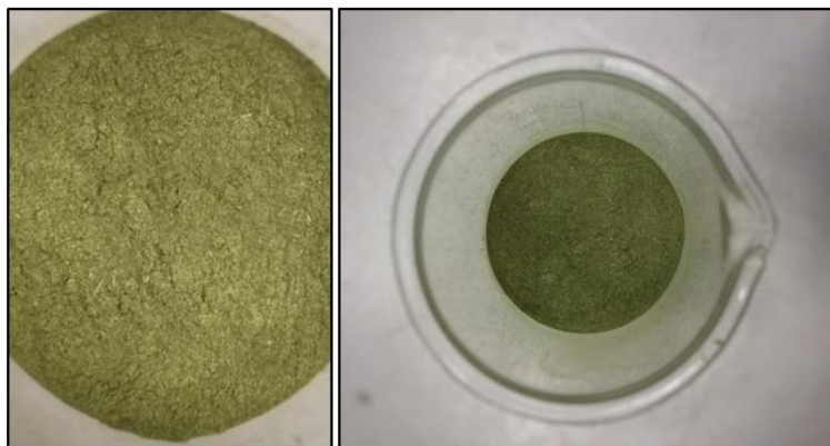
Figura 9. Muestra vegetal de Ambrosia peruviana deshidratada y triturada para extracción con dióxido de carbono supercrítico (CO 2 -SC).
