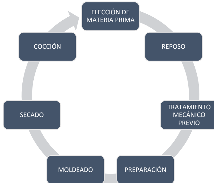
Figura 51: Proceso de fabricación del ladrillo
