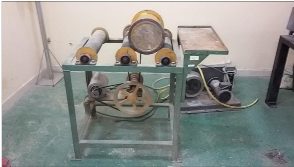
Figura 5. Molino de bolas tipo Batch modelo C 560 394. Elaboración y fuente: el autor.
