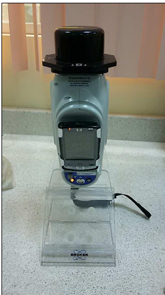
Figura 13. Equipo de fluorescencia marca "BRUKER S1".
