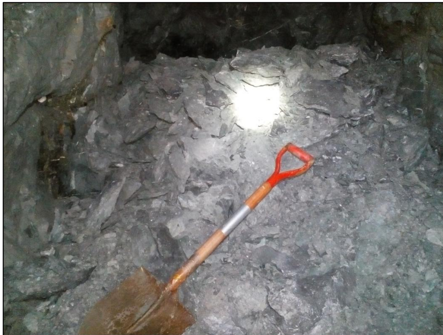
Figura 18. Granulometría del material quebrado después de la voladura. Fuente: El autor. Elaboración: El autor.
