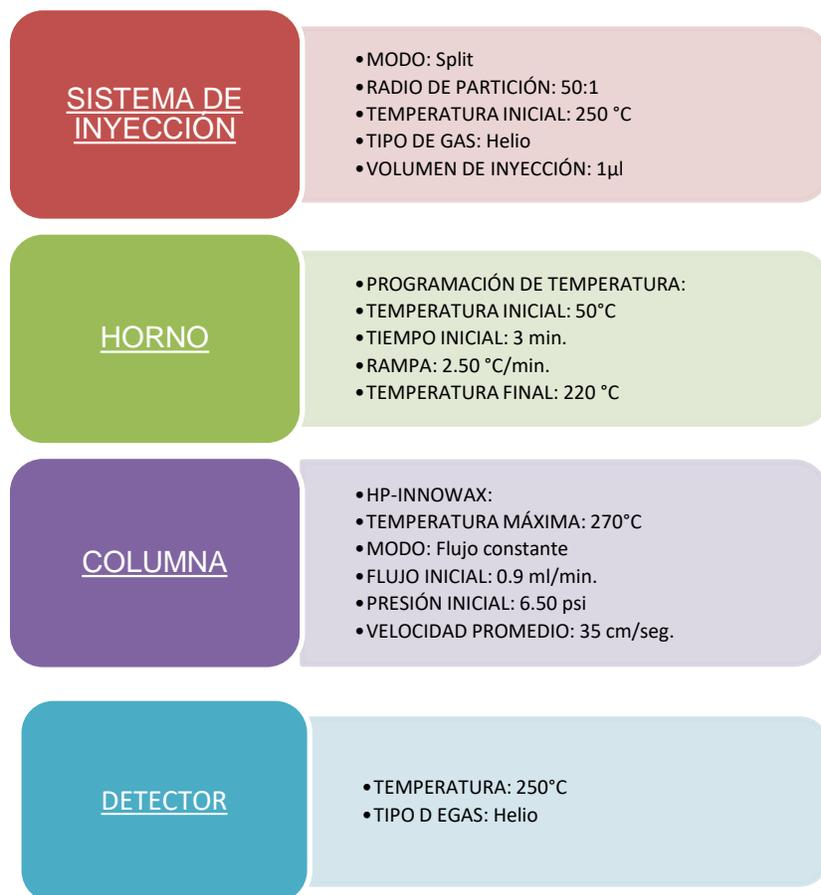
**Figura 7.** Condiciones operacionales para la corrida cromatográfica en la columna polar HP-INNOWAX.
