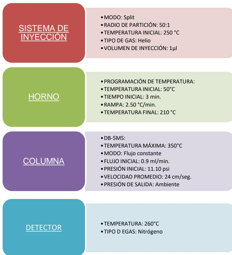
**Figura 8.** Condiciones operacionales para la corrida cromatográfica en la columna no polar DB-5MS acoplada al detector de ionización en llama CG-FID.
