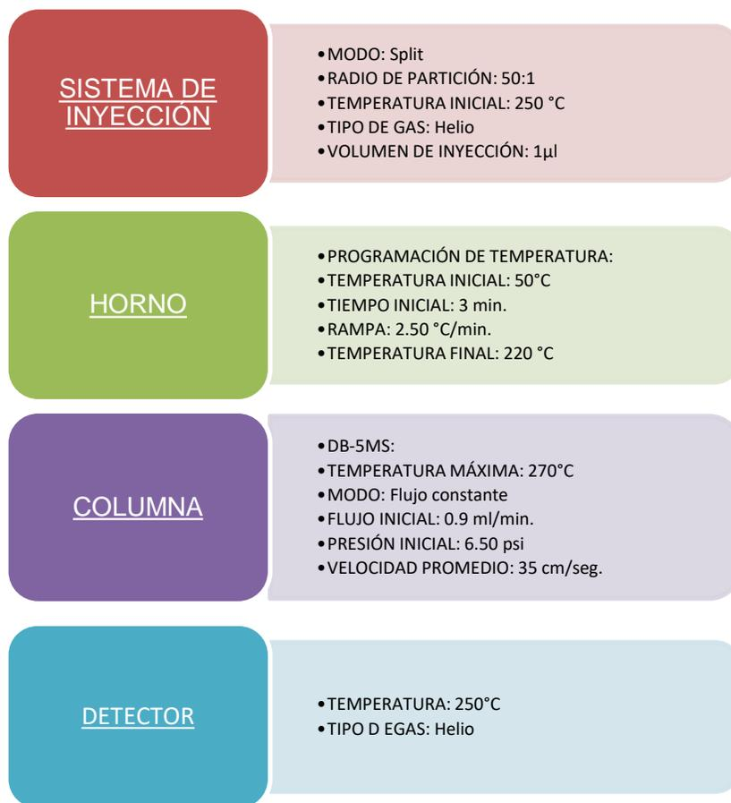
**Figura 6.** Condiciones operacionales para la corrida cromatográfica en la columna no polar DB-5MS
