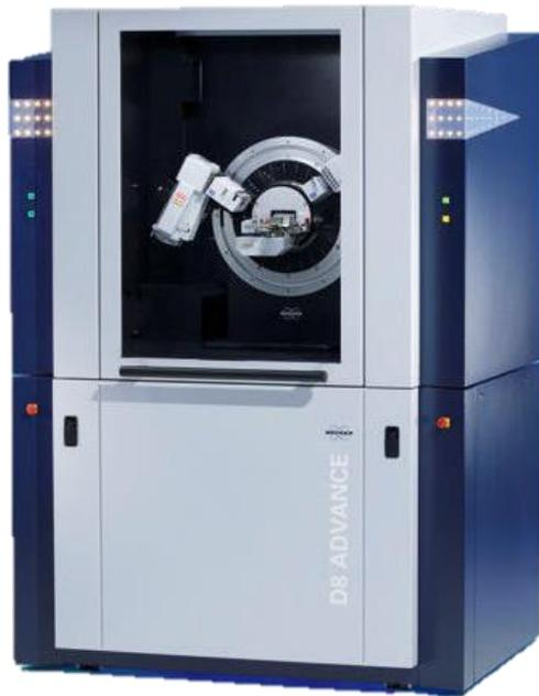
Figura 14. Equipo de Difractometría de Rayos – X D8 ADVANCE ECO.
