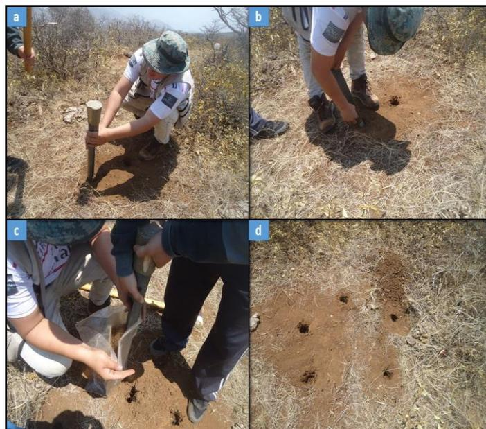
Figura 7. Toma de muestra de suelo de la zona de estudio: a) Colocación del tubo muestreador. b) Extracción del tubo muestreador con muestra de suelo. c) Enfundando y etiquetando la muestra de suelo obtenido. d) Pentágono del muestreo de suelo realizado.
