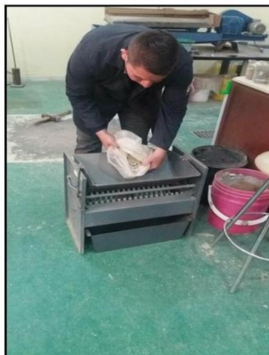
Figura 11. Colocación de muestra en el cuarteador tipo Rifle.
