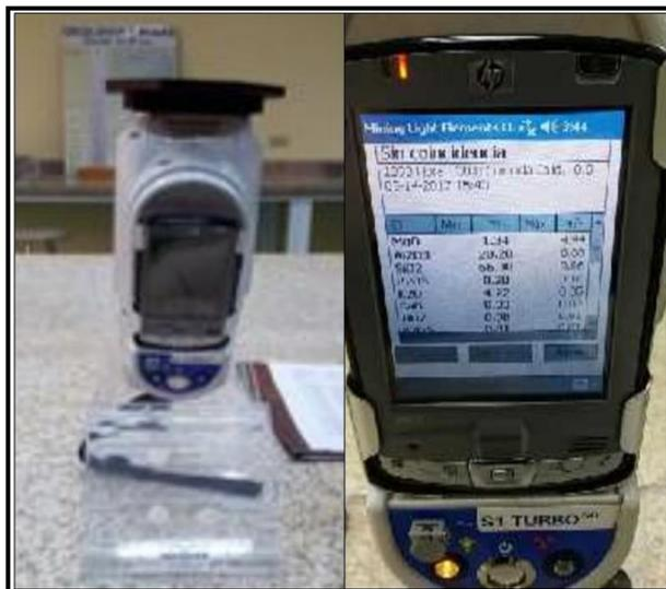
Figura 13. Equipo de Fluorescencia portátil de Rayos-X S1 TURBO<sup>SD</sup>.
