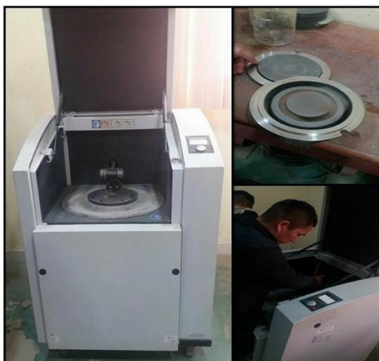
Figura 12. Colocación de la muestra en el pulverizador rotatorio de anillo.
