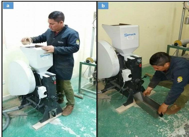
Figura 10. Trituradora de Mandíbulas Restch: a) Colocación de muestra de suelo. b) Extracción de la muestra triturada.
