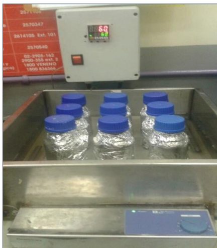
Figura 6. Extracción de antioxidantes del subproducto de mortiño
