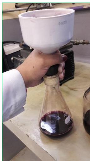
Figura 7. Filtración al vacío del extracto del subproducto de mortiño
