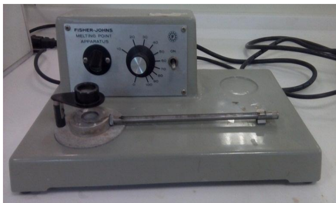
Figura. 11 Equipo Fisher-Johns Fuente: Autor, 2018 Elaboración: Autor, 2018
