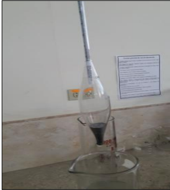
Ilustración 22. Hidrómetro 152 H usado en el ensayo. Fuente: Autor. Elaboración: Autor.
