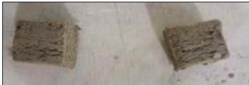
Ilustración 18. Cubos remoldados para ensayo de Crumb.
