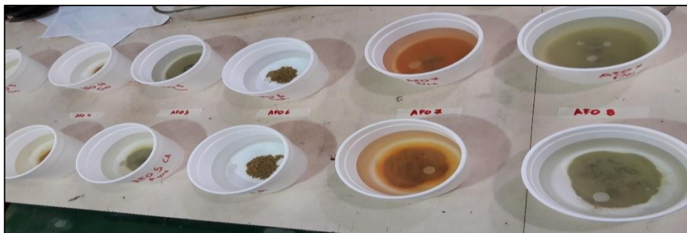
Ilustración 19. Ensayo de Crumb.
