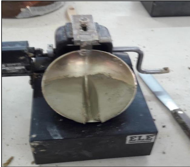
Ilustración 16. Determinación de límite líquido.
