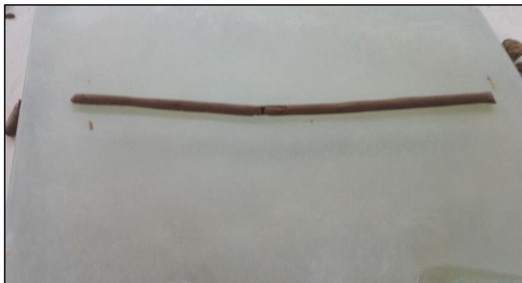
Ilustración 17. Cálculo de límite plástico.
