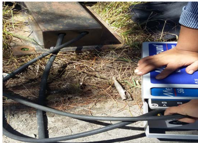
Figura 6. Colocación de sensor en estación primaria Nro.1, Km 7+100
