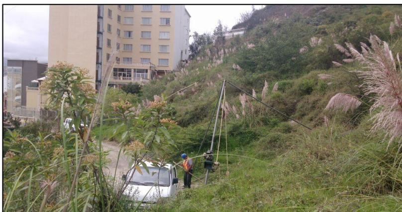
Figura 19. Ensayo SPT al pie de la ladera
