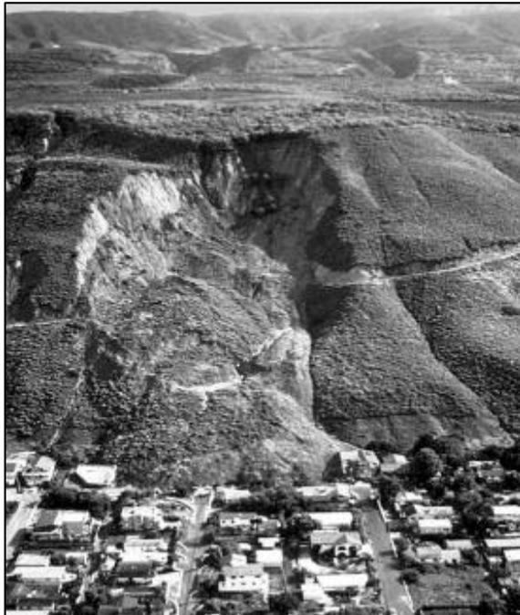
Figura 2. Deslizamiento rotacional la Conchita, en California
