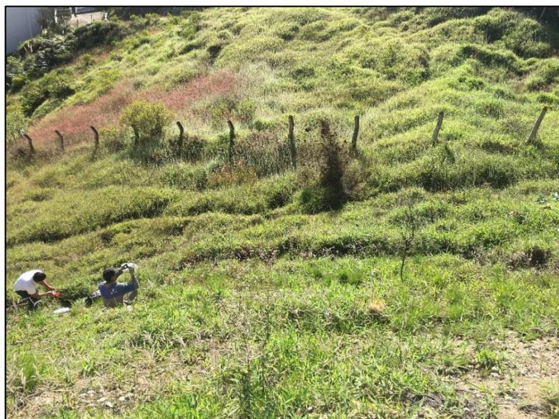
Figura 18. Ensayo de sísmica de refracción en zona de estudio
