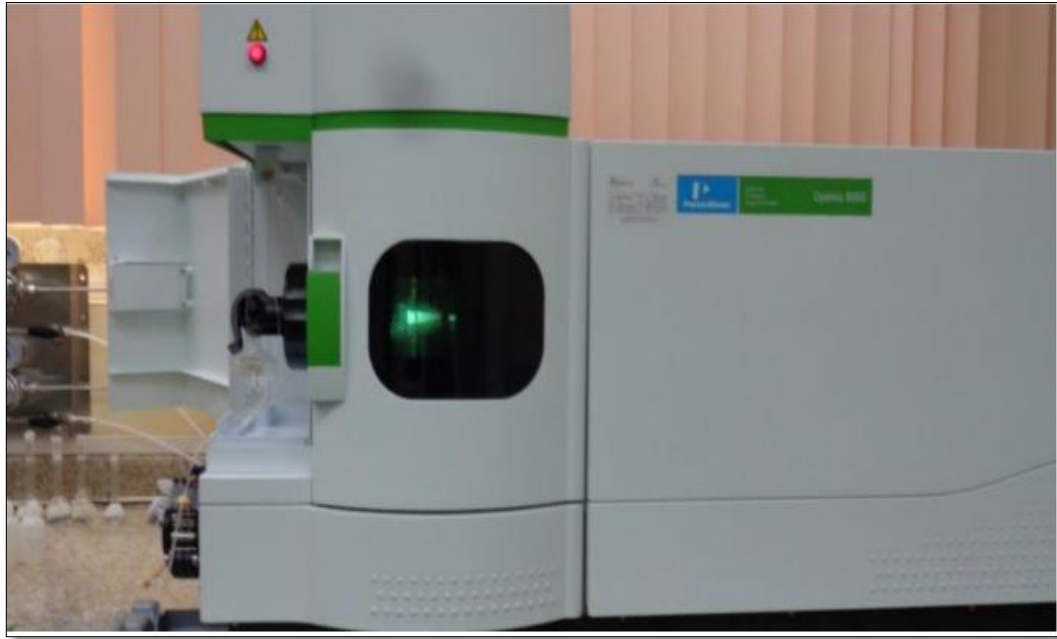
Figura 5. Equipo Óptima 83000 ICP - AES Spectrometer. Fuente: PerkinElmer Inc. (2017) Elaborado: El autor
