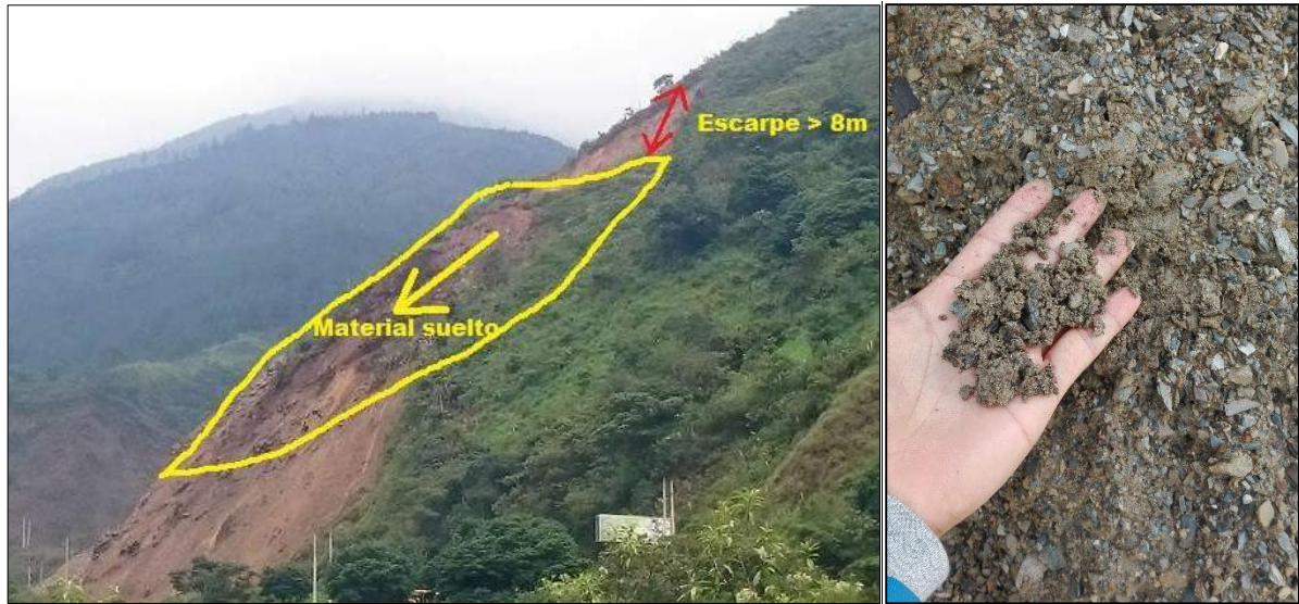
Figura 3.7: Deslizamiento traslacional y tipo de material predominante ubicado en la abscisa 30+600, Fuente: Marco Antonio Álvarez Elaborado por: Marco Antonio Álvarez
