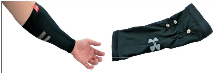
Figura 3.3 Elaboración de electrodos a base de tela conductiva
