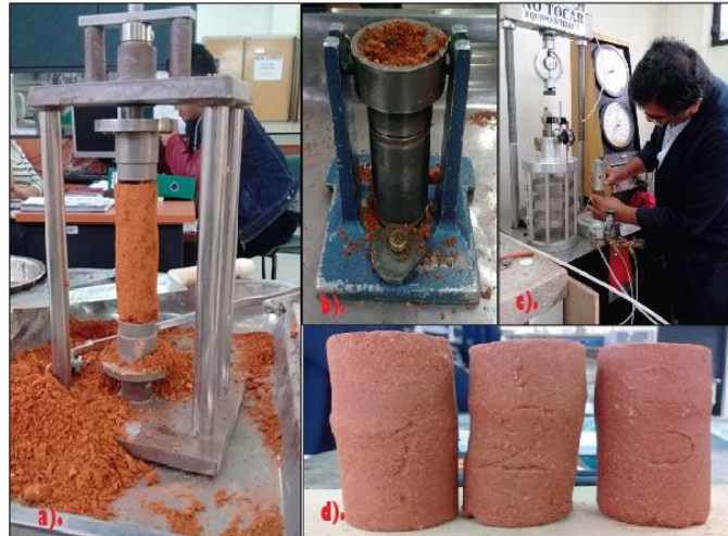
Foto 15: a). Perfilador con muestra PM2 inalterada; b). Remoldeo de muestra PM3 alterada; c). Preparación del equipo; d). Fallamiento de probetas.
