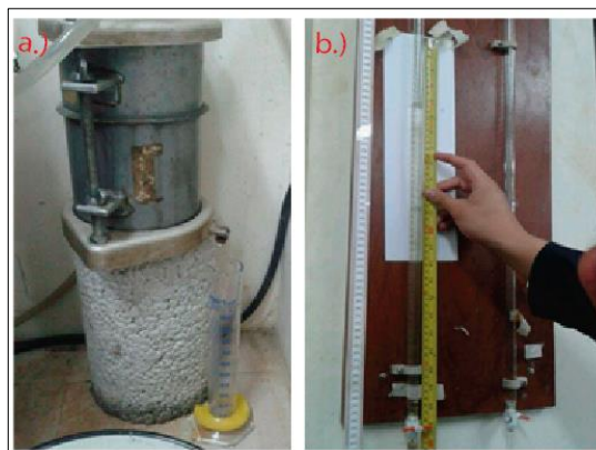
Foto 16: a.) Recolección de caudal; b.) Medida de las alturas en el tubo piezométrico.
