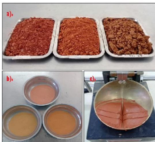
Foto 13: a). Muestras secadas al ambiente; b). Muestras pasadas por el tamiz # 40; c). Casagrande con muestra después de 15 golpes.
