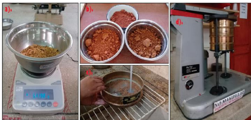
Foto 12: a). Muestra pesada antes de lavado; b). Muestras pesadas (5kg) para realizar granulometría; c). Lavado de muestra por el tamiz #200; d). Tamizador.
