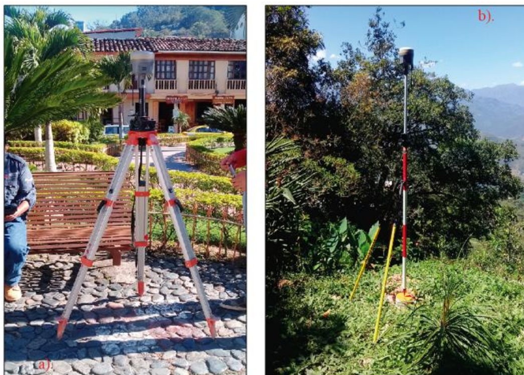
Foto 3: a). Receptor base ubicado en el Parque Central de Zaruma. b). Receptor móvil sobre punto de control (Gonzalo Pizarro).
