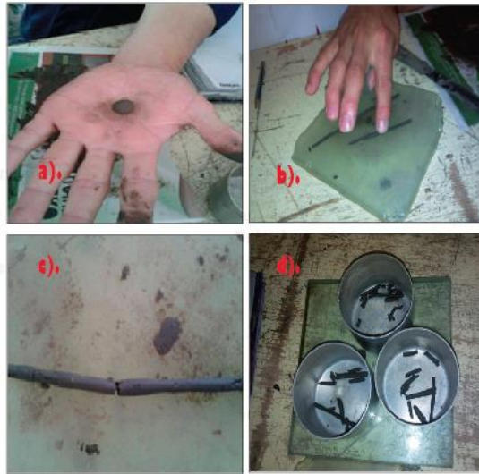
Foto 14: a.) Muestra de 1 cm de diámetro; b). Muestra sobre el vidrio esmeril; c). Fractura de la muestra; d). Muestra fracturada en taras.
