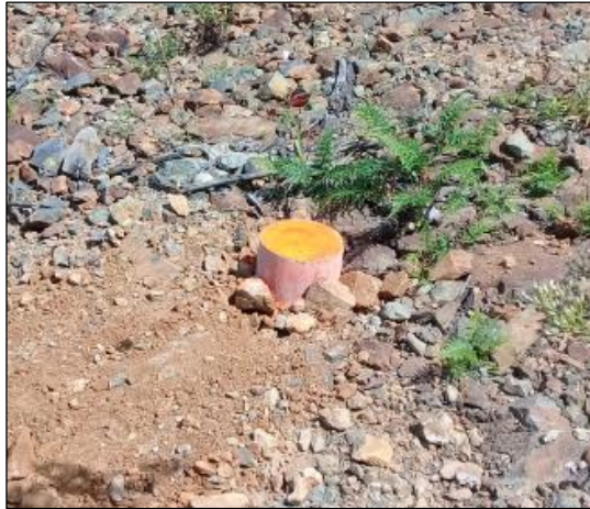
Foto 4: Mojón cilíndrico de hormigón, sirve como punto de control.
