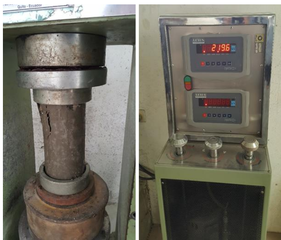
Figura 6.8: Ensayo de compresión simple del concreto (15 días).
