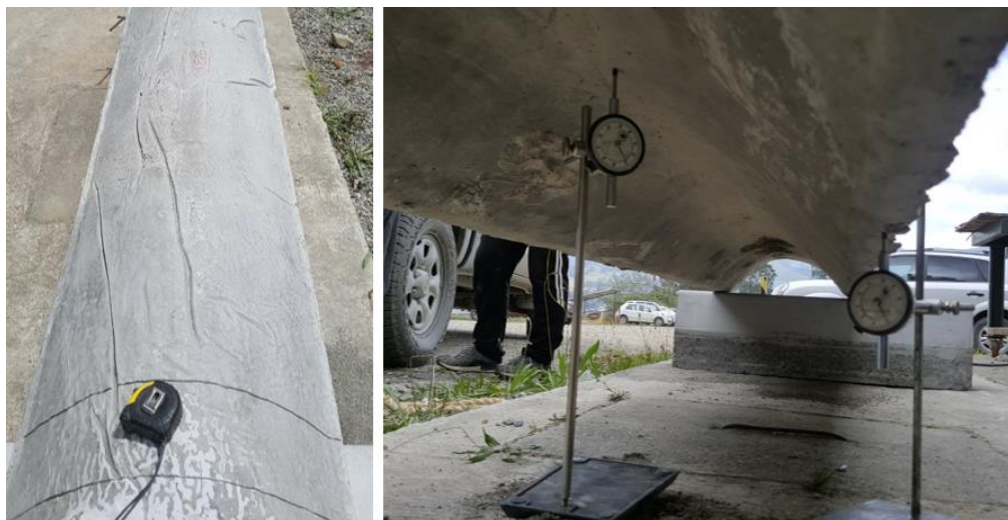
Figura 6.4: Preparación de la LPF previo a comenzar el ensayo de flexión
