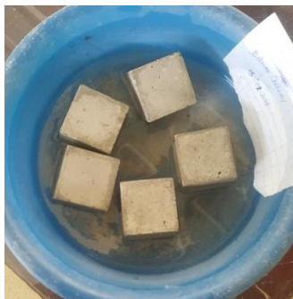
Figura 6.1: Muestras de mortero (cubos de 26.01\text{cm}^2 )
