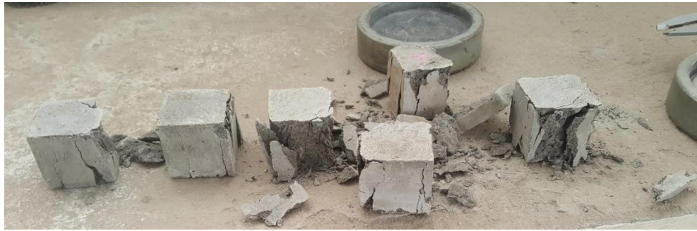
Figura 6.3: Cubos de mortero luego de ser probados.
