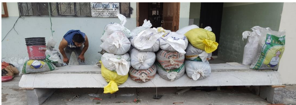
Figura 6.12: Prototipo de entrepiso (ensayo de flexión).
