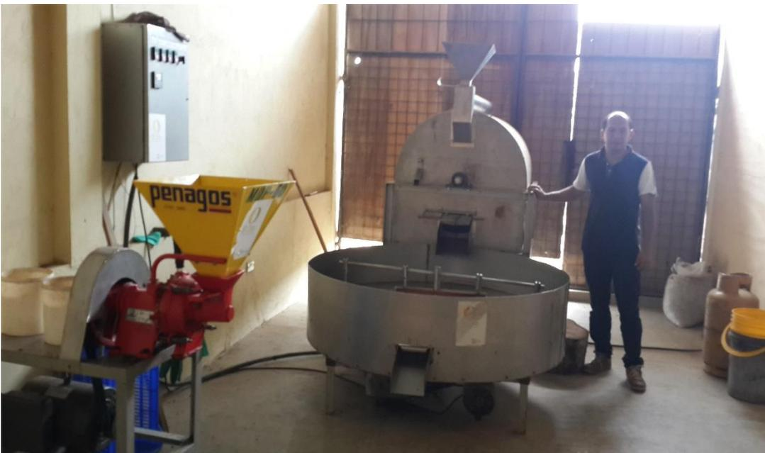
Foto 6: Horno de tostado y molino de discos
