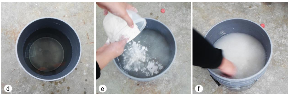
Figura 26. En 15 litros de agua se diluye 150gr de cal apagada.
