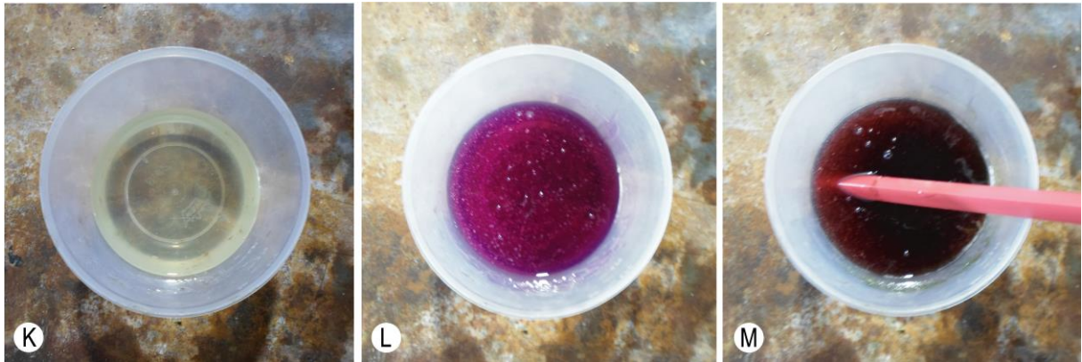
Figura 45. Mezclado de la resina poliéster con el cobalto y mek.
