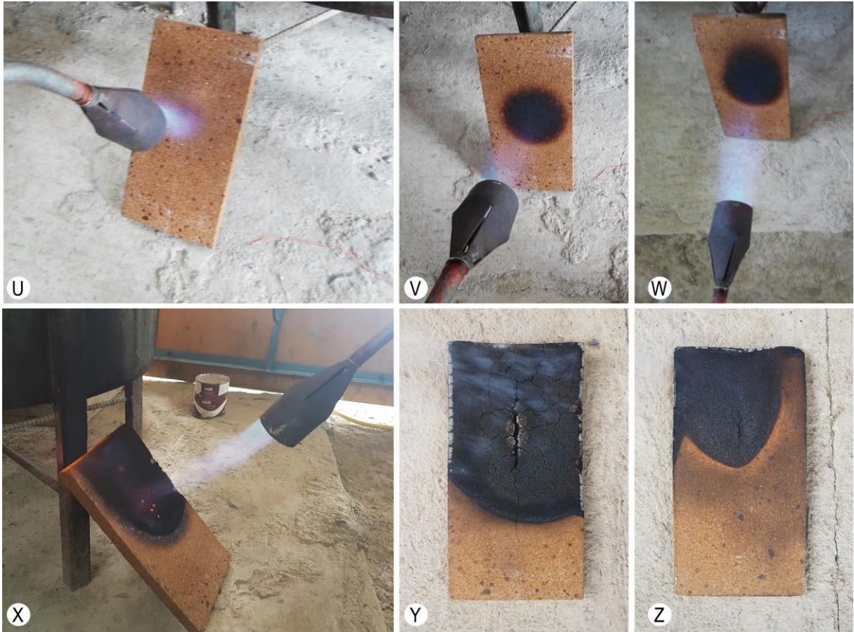
Figura 70. Ensayo de la resistencia al fuego.
