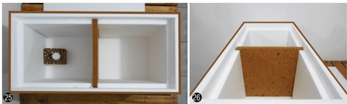
Figura 38. Caja para pruebas de acústica global y transferencia de calor.
