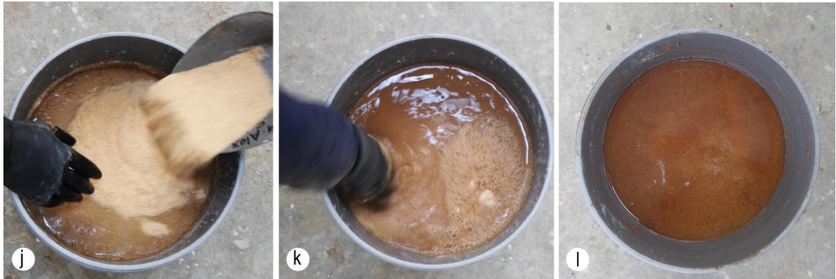
Figura 28. Sumergir el aserrín en agua con cal apagada.
