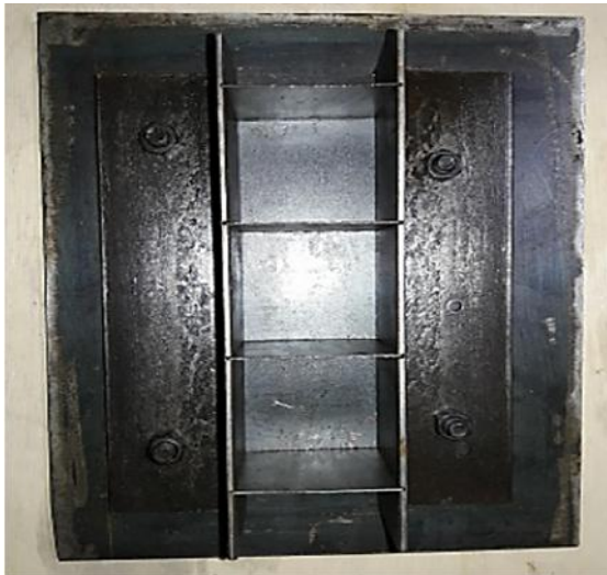
Figura 23. Moldes de acero.
