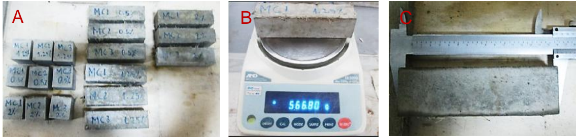
Figura 49. Pesado de muestras previo al ensayo flexión.
