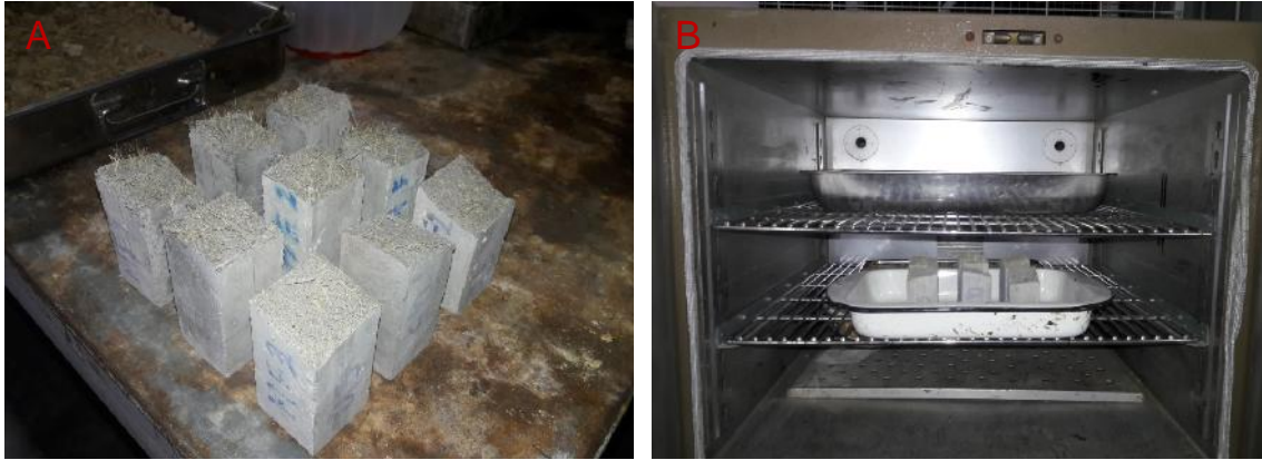
Figura 64. Secado de probetas.
