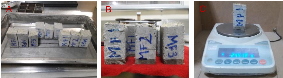
Figura 65. Elaboración de ensayo absorción por capilaridad.
