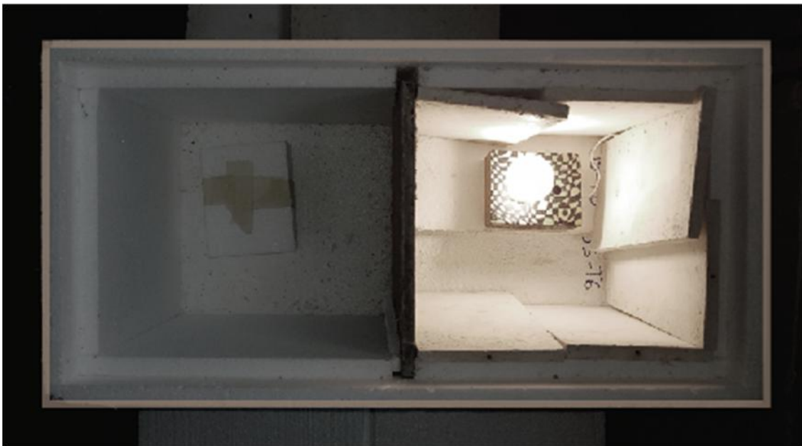
Figura 81. Equipo para ensayo conductividad termica y trasmittancia térmica.
