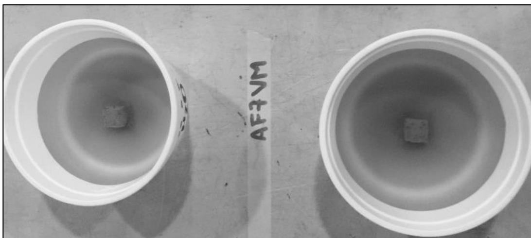
Ilustración 11. Ensayo de Crumb, muestra con dispersión
