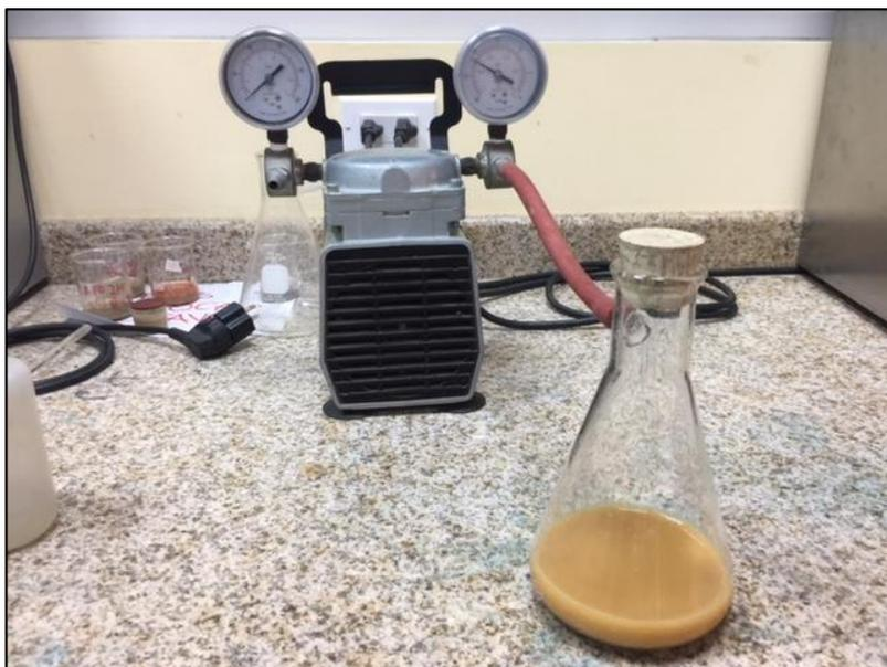
Ilustración 14. Bomba de vacío conectada al matraz con la muestra
