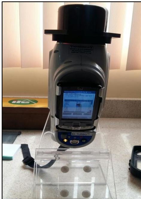
**Foto 4.** En esta foto se visualiza el ensayo de fluorescencia de rayos X.
