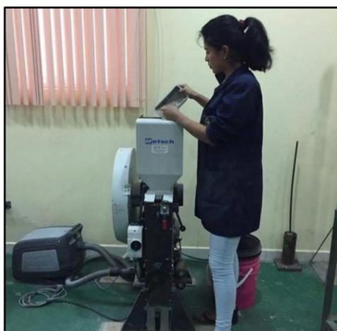
**Foto 1.** Trituración de la muestra en una trituradora de mandíbulas marca RETSCH modelo BB100.
