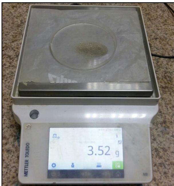
**Foto 3.** Peso de la muestra platoneada para análisis mineralógico.
