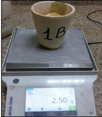
**Foto 12.** Peso de los reactivos en un crisol refractario debidamente etiquetado para fusión en la balanza analítica.
