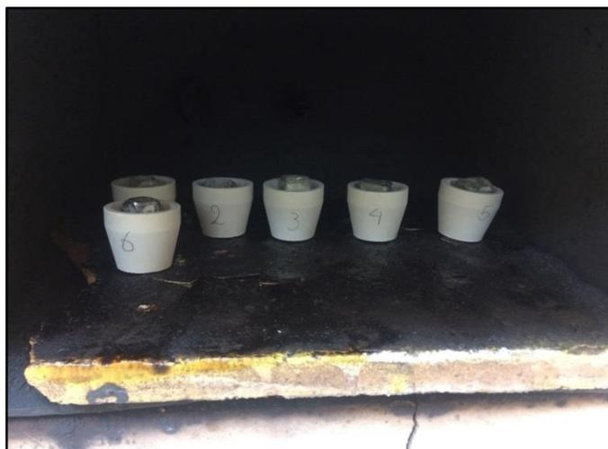
**Foto 16.** Muestras preparadas para copelación en el horno.
