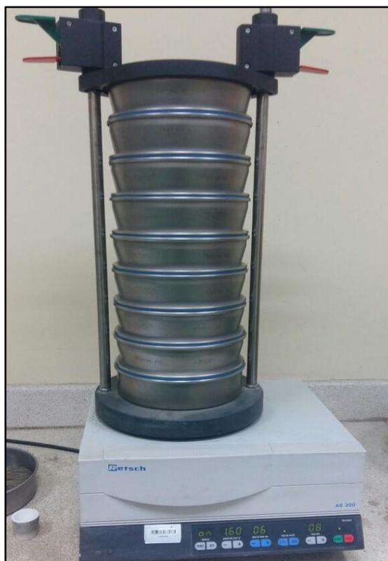
**Foto 9.** Análisis granulométrico de la muestra.
