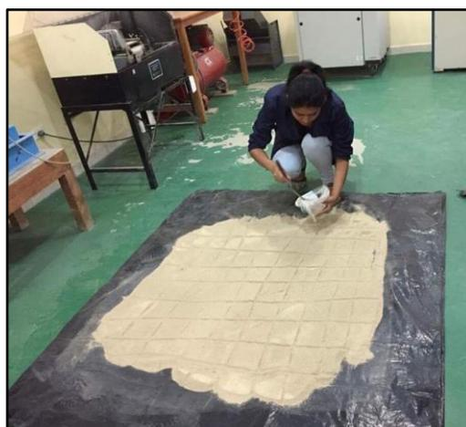
**Foto 2.** Cuarteo a través de un mallado y distribución de la muestra en fundas Ziploc de un kilogramo.
