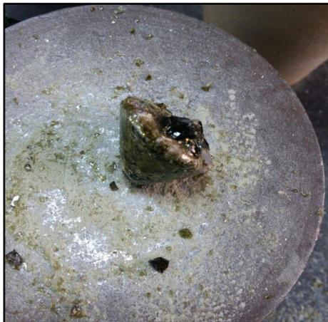
**Foto 14.** Visualización del régulo de plomo una vez separado de la escoria.
