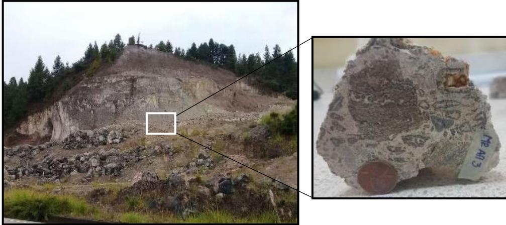
Figura 7. Afloramiento de brecha hidrotermal
