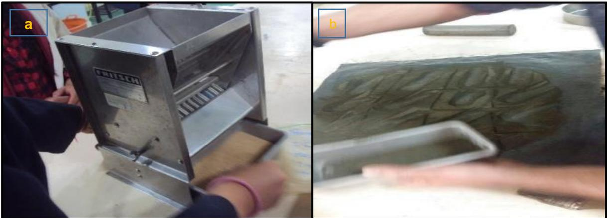
Figura 15. Homogenización con tamizador (a) y homogenización manual (b)
