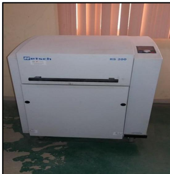
Figura 14. Pulverizadora Retsch RS 200
