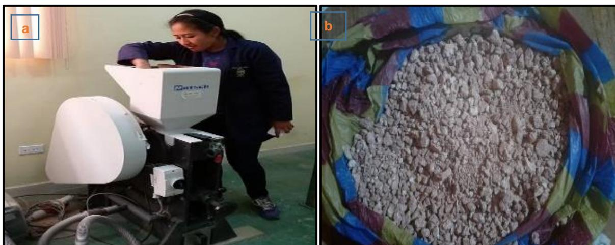
Figura 12. Trituradora Retsch BB200 WC laboratorio UTPL (a) y Trituración primaria de roca (b).
