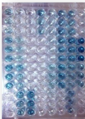
Figura 22. Muestras en ensayo ABTS con cambio de coloración azul a transparente.
