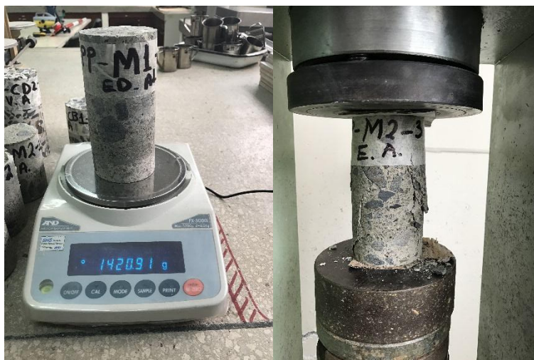
Fotografía 4. 5. Compresión simple de núcleos Edificio Albatros y Vista Azul. Fuente: El Autor. Elaboración: El Autor.
