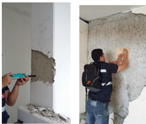
Fotografía 4. 9. Martillo esclerométrico silverschmidt. Fuente: El Autor. Elaboración: El Autor.
