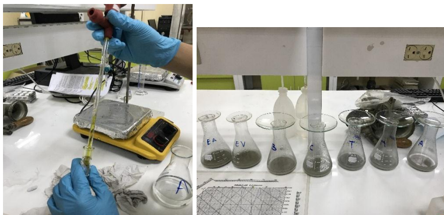
Fotografía 4. 6. Titulaciones con Nitrato de Plata para la determinación del ion Cl. Fuente: El Autor. Elaboración: El Autor.
