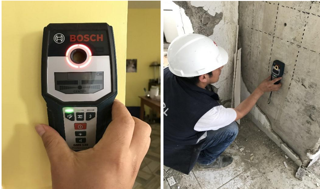
Fotografía 3. 7. Detector de acero de refuerzo – Mapeo y localización de varillas Fuente: El Autor. Elaboración: El Autor.
