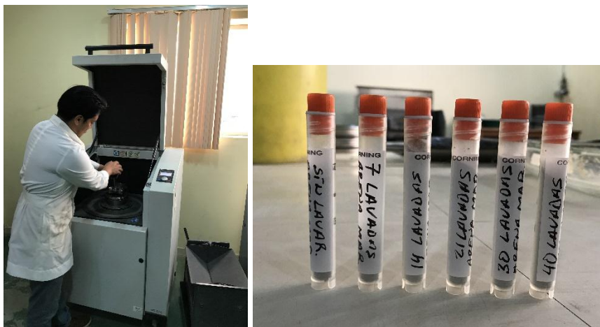
Fotografía 4. 8. Pulverización de la arena de mar. Fuente: El Autor. Elaboración: El Autor.
