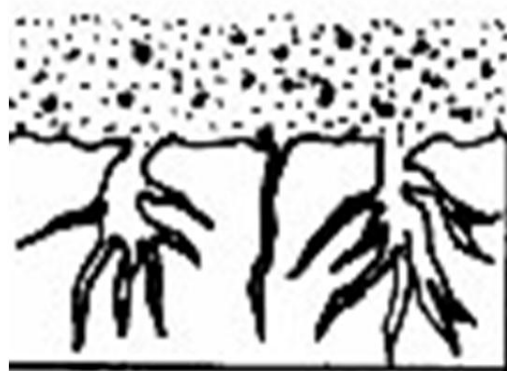
Figura 2. 8. Corrosión bajo esfuerzo Fuente: (González, 2014) Elaboración: (González, 2014)
