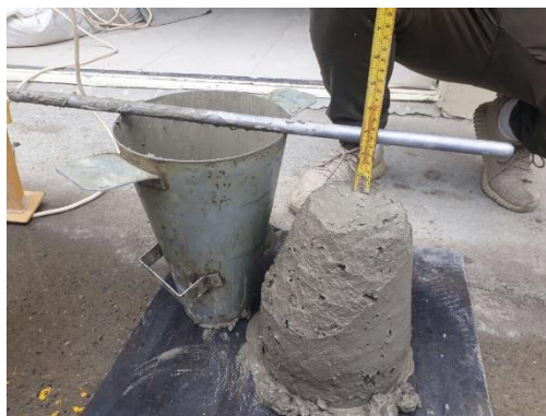
Fotografía 4. 4. Asentamiento Mezcla Clase T.
