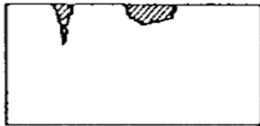
Figura 2. 6. Ejemplo de corrosión localizada Fuente: (González, 2014) Elaboración: (González, 2014)
