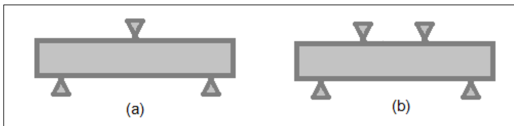
Figura 2. 19. Ensayo para determinación del módulo de rotura del hormigón, (a) viga con carga en el punto central, (b) viga con carga en los tercios.
