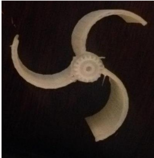
Figura 34. Vista general de la turbina con tres álabes curvos impresa Fuente: Autores Elaboración: Autores
