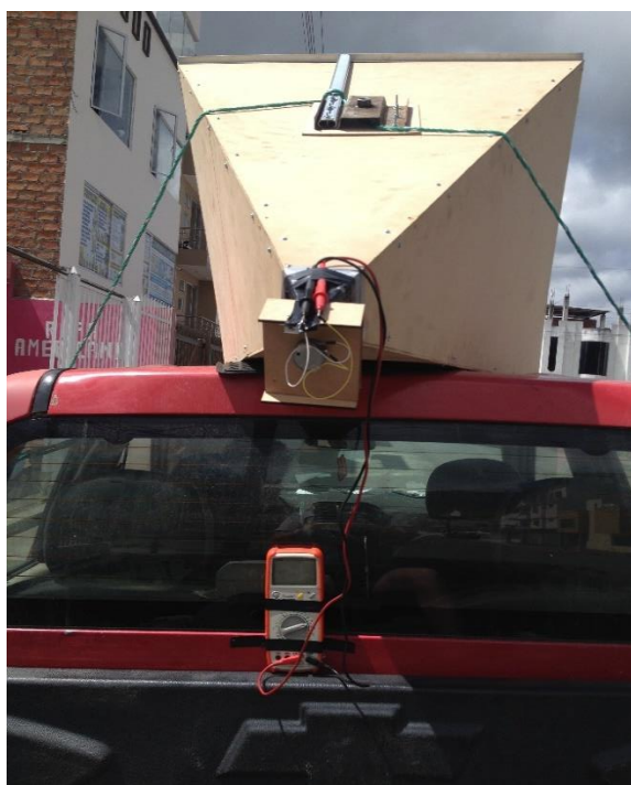
Figura 36. Vista general del microaerogenerador montado en la plataforma de pruebas
