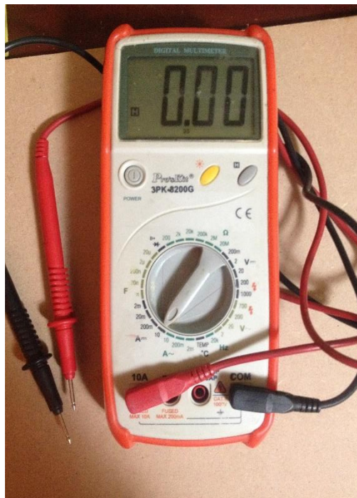
Figura 32. Vista general del multímetro ProsKit 3PK-8200G utilizado para las mediciones de corriente y voltaje
