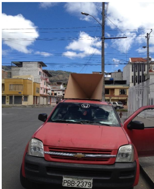
Figura 22. Vista general de la estación de trabajo improvisada para medir el desempeño de las toberas del prototipo Fuente: Autores Elaboración: Autores
