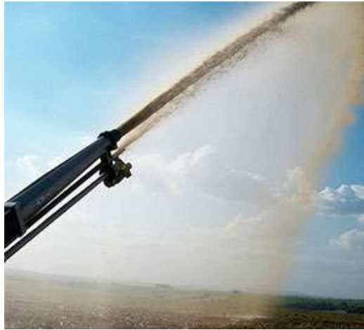
Figura 3. Aspersor de impacto con dos boquillas. Fuente: Peña, 2012. Elaboración: Peña, 2012.
