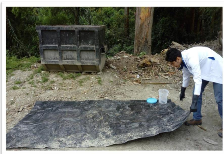
**Figura 4.** Método de cuarteo para la caracterización física de los residuos sólidos.
