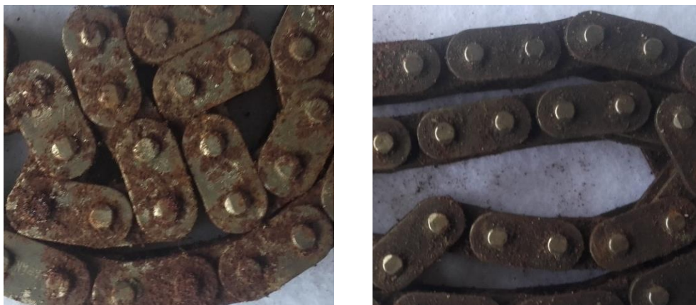
Figura 30. Deterioro de la pigmentación de la pieza de chatarra (dcha) resultado de la oxidación (izq.).
