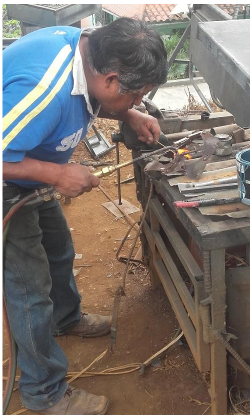
Figura 57. Soldadura autógena para el ensamblaje de la pieza. Fotografía: Johanna Iñiguez.
