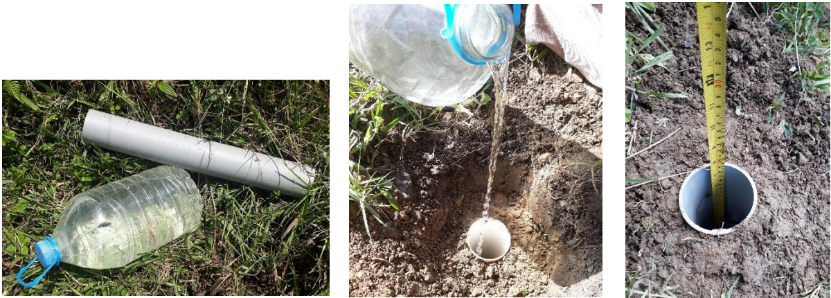
Figura 8. Ensayo de permeabilidad in situ por el método de Lefranc.
