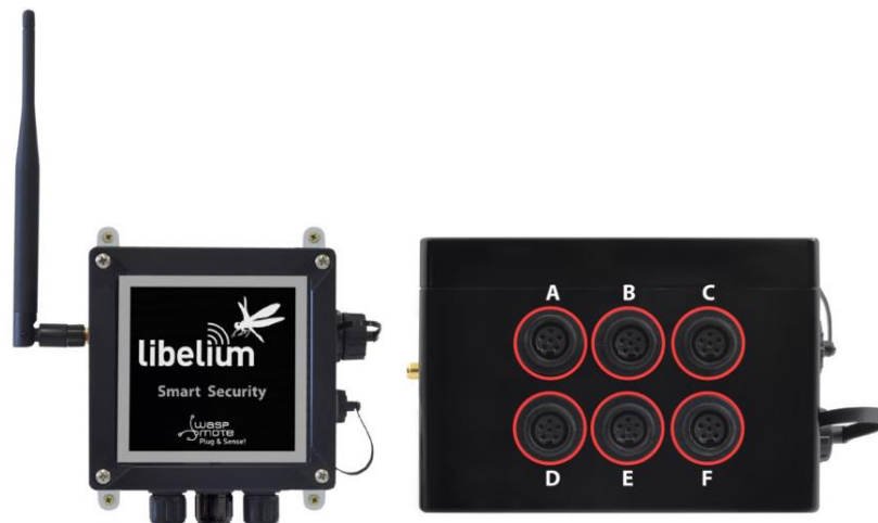
Figura 3.4.1. Distribución de sockets para los sensores para Wasmote Plug and Sense! Fuente y elaborado por [44].
