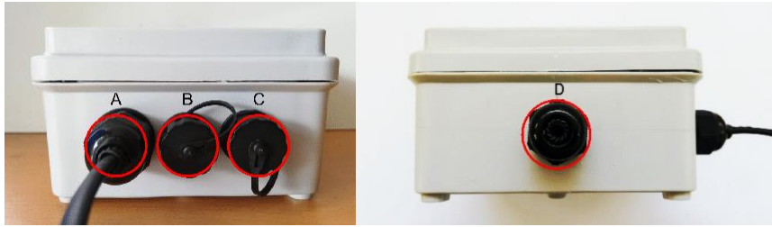
Figura 3.6.10. Distribución de sockets en la Caja de Acondicionamiento. Fuente: Elaborado por los autores.
