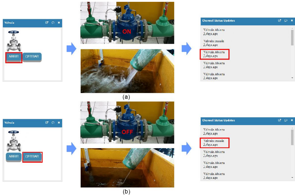
Figura 4.3.6. Proceso de funcionamiento del nodo de control de electroválvula. Fuente y elaborado por los autores, basados en [31].
