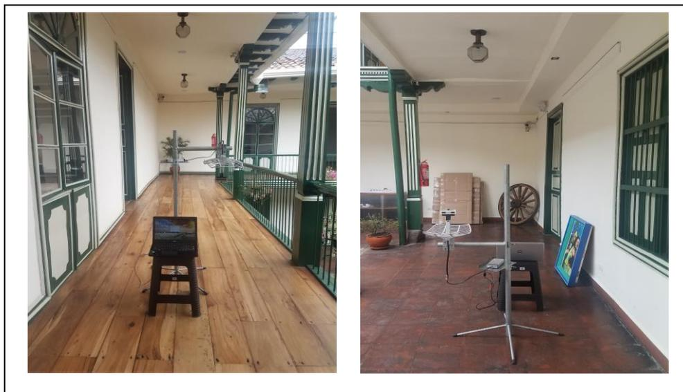
Figura 4.52. Medición realizada sobre el entrepiso de madera.
