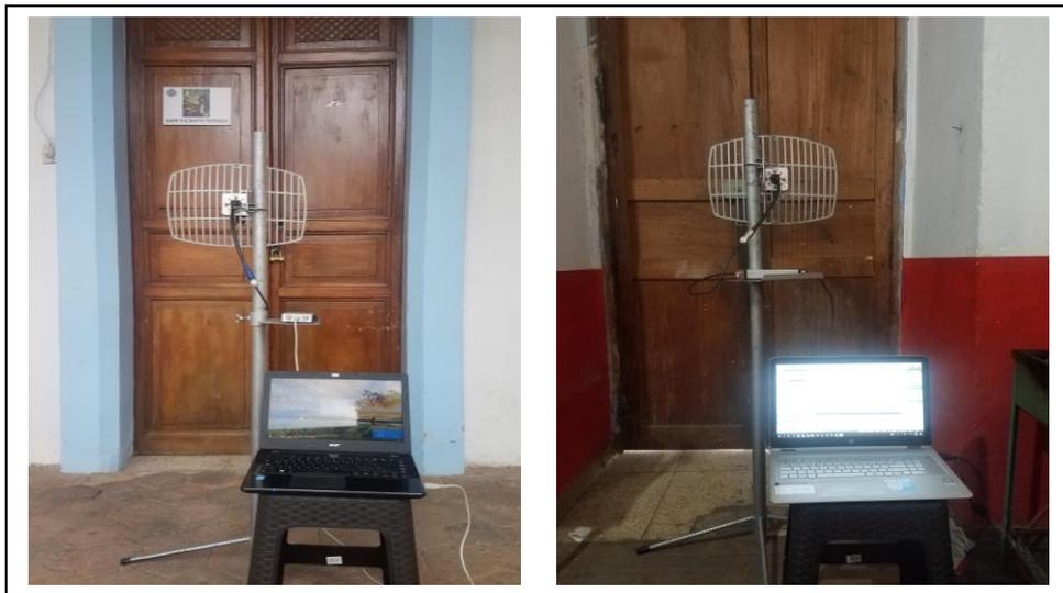
Figura 4.31. Medición realizada sobre una puerta de madera.
