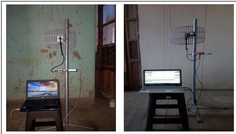
Figura 4.33. Medición realizada sobre una pared de tapia de 30 cm.
