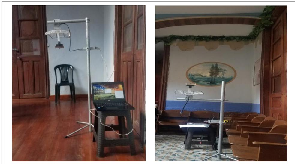
Figura 4.11. Medición realizada sobre el entrepiso de madera de la edificación.
