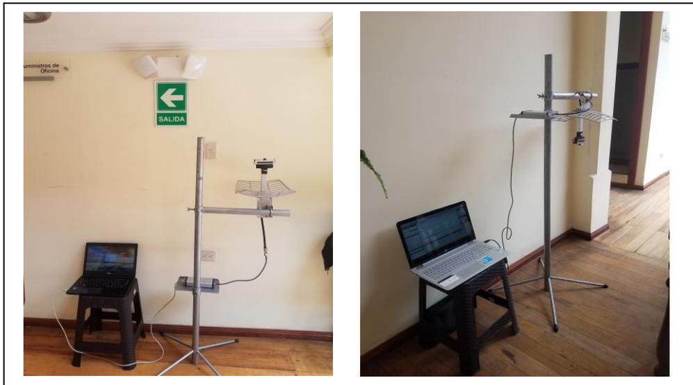
Figura 4.23. Medición realizada sobre el entrepiso de madera-gypsum de la edificación.
