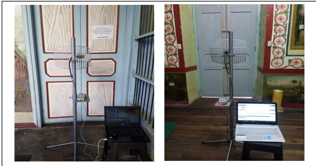
Figura 4.7. Medición realizada sobre una puerta de madera de la edificación.
