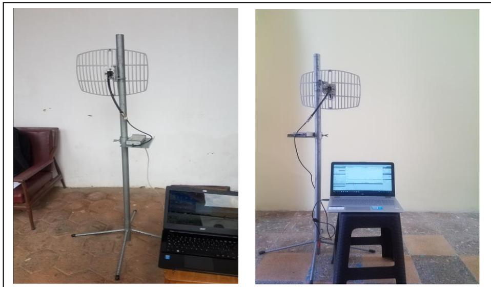
Figura 4.29. Mediciones realizadas sobre dos paredes de tapia de 65 cm
