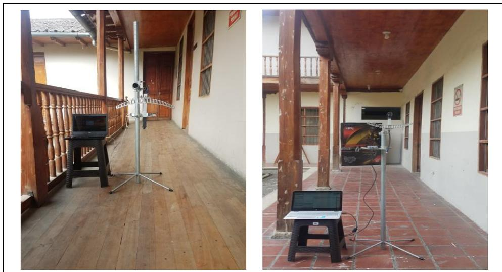
Figura 4.42. Medición realizada sobre el entrepiso de madera de la edificación.
