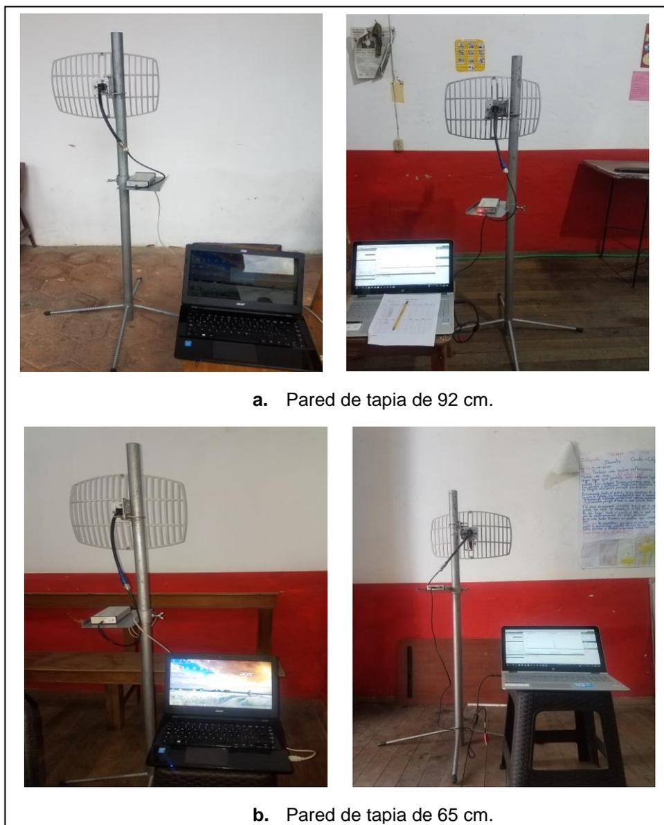
Figura 4.27. Mediciones realizadas sobre paredes de tapia de la edificación.
