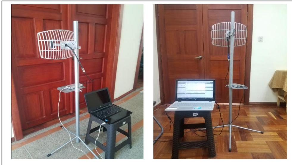
Figura 4.19. Medición realizada sobre una puerta de madera de la edificación.
