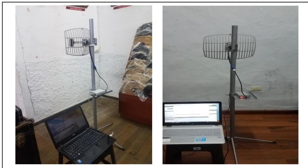
Figura 4.5. Medición realizada sobre dos paredes de tapia de 66 cm.
