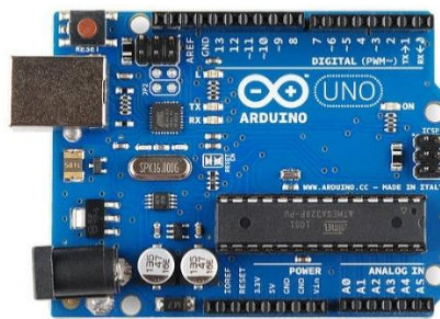
Figura 13. Arduino Uno R3 Fuente: (arduino.cl, 2013) Elaboración: (arduino.cl, 2013)
