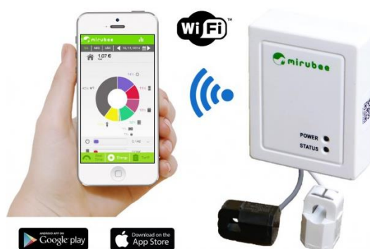
Figura 1. Medidor Mirubee Mirubox con aplicación móvil Fuente: (efimarket.com, 2017) Elaboración: (efimarket.com, 2017)
