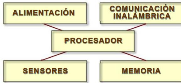
Figura 6. Diagrama de bloques de las partes de un nodo Fuente: (Fernández Martínez et al., 2009) Elaboración: (Fernández Martínez et al., 2009)
