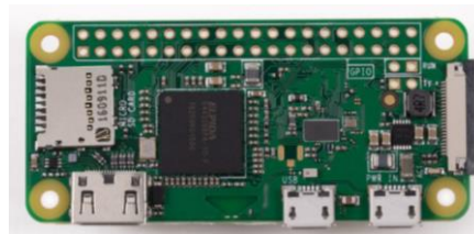
Figura 12. Raspberry pi zero w Fuente: (Raspberry, 2017) Elaboración: (Raspberry, 2017)
