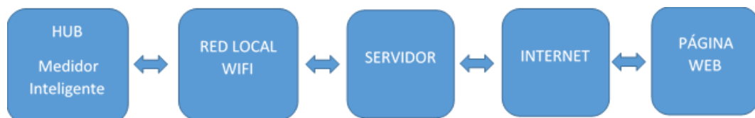
Figura 10. Diagrama de bloques del funcionamiento del sistema
