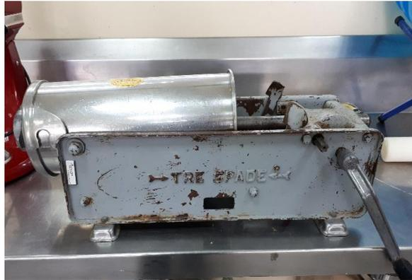
**Figura 7.** Embutidora metálica manual
